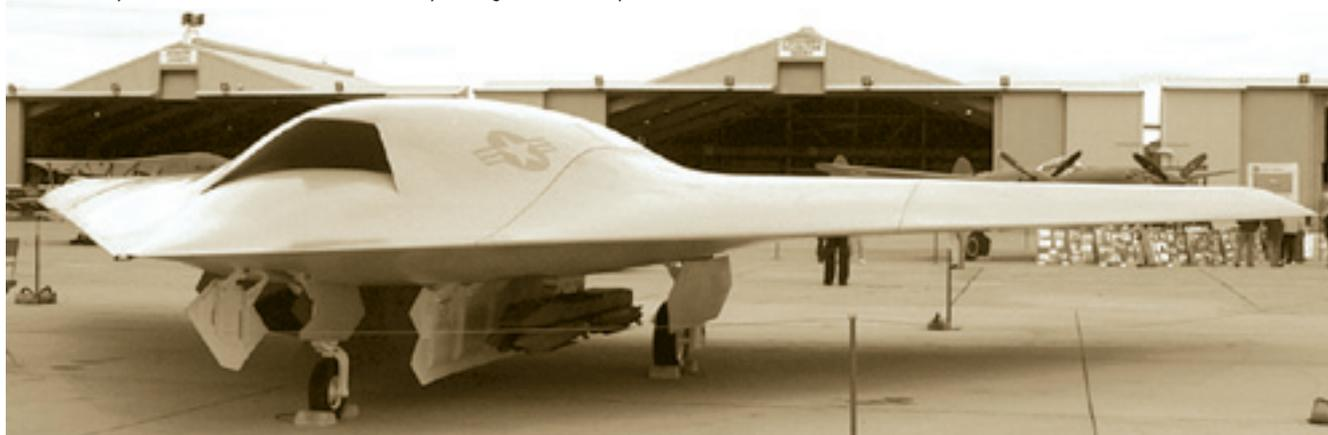
**Беспилотные аппараты X-45B были намного крупнее демонстраторов X-45A. Их полезная нагрузка составляла почти 2 тонны**
