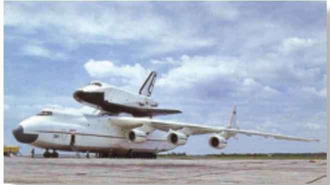
**Орбитальный самолёт «Буран» готов к воздушной транспортировке на самолёте-носителе Ан-225 на авиасалон в Ле Бурже**
