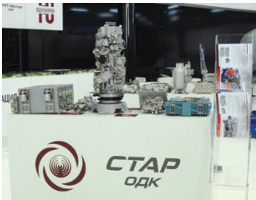
*Системы автоматического управления ГТД разработки ОАО «СТАР»*
