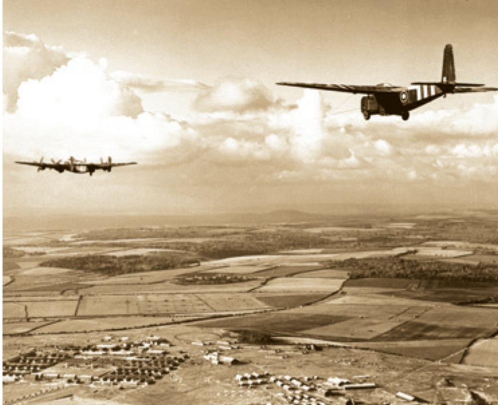
**Учебный полёт для пилотов буксировщика и планера. Галифакс буксирует Хамилькар в районе Блэнфорда, графство Дорсет. Виден Y-образный буксировочный леер. На планер нанесены знаки быстрого опознавания – так называемые «Полосы вторжения». Май 1944 г.**
