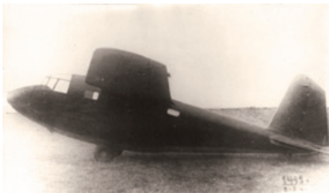
Прототип планера Г-11. Видно, что крыло расположено близко к кабине пилота, и само крыло имеет прямую переднюю кромку, без излома
