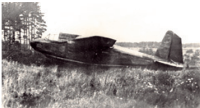
Серийный образец планера Г-11. Крыло отодвинуто назад для создания более передней центровки
