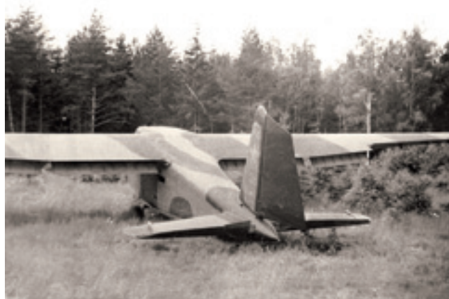
Планёр Г-11, вид сзади. Планёр имеет камуфляжную окраску. Щитки выпущены. Противовибрационные грузы руля высоты легли на стабилизатор – руль в крайнем поднятом положении. На руле виден триммер
