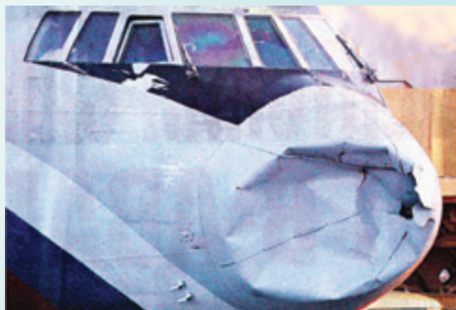
На фотографии лобовая часть самолета Ил-96 после столкновения с птицей. Еще немного – и удар в стекло, разгерметизация самолета и все другие последствия.
