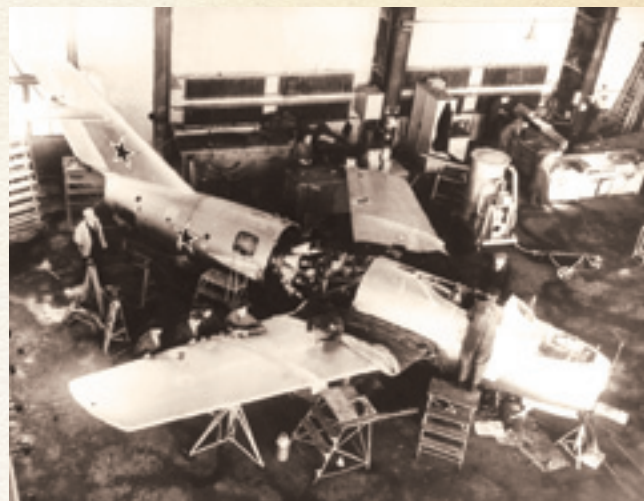
Сборка самолета МиГ-15 с двигателем РД-45Ф
