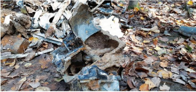
Фрагменты карбюратора мотора М88б
