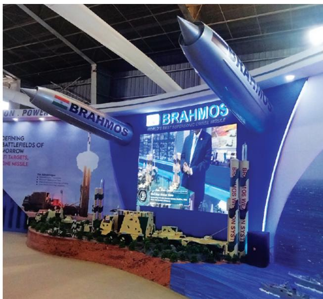
Brahmos — это двухступенчатая крылатая ракета с твердотопливной стартовой первой ступенью, которая разгоняет ее до сверхзвуковой скорости, после чего она отделяется. Ракета имеет дальность полета до 290 километров и в течение всего полета сохраняет сверхзвуковую скорость. Ракетные комплексы Brahmos уже состоят на вооружении Индии.
