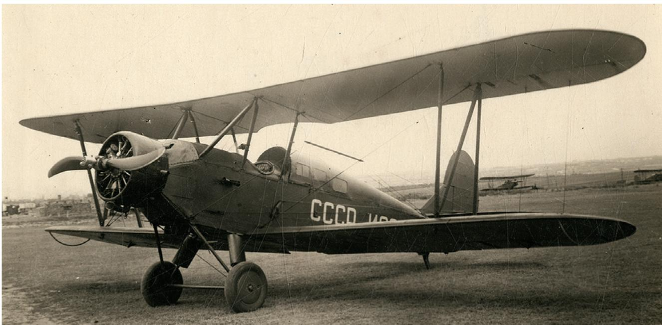
Самолёт По-2Л с мотором М-12
