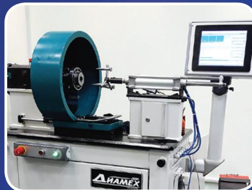
Стенд проверки подшипников СП-180М
