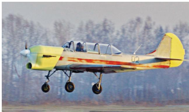
Летные испытания двигателя-демонстратора АПД-А в составе летающей лаборатории на базе самолета Як-52, 2022 год
