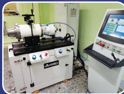
Стенд испытаний шпиндельных узлов
