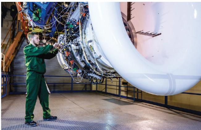
Первый опытный двигатель ПД-8 на испытательном стенде ОДК-Сатурн
