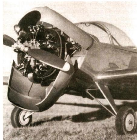
Опытный УТС Як-20 с мотором М-10
