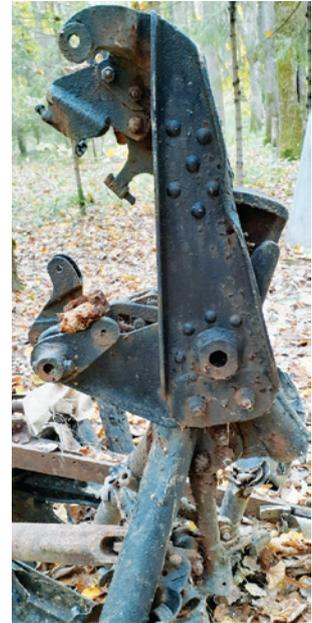
Фрагмент стойки шасси ДБ-3Ф
