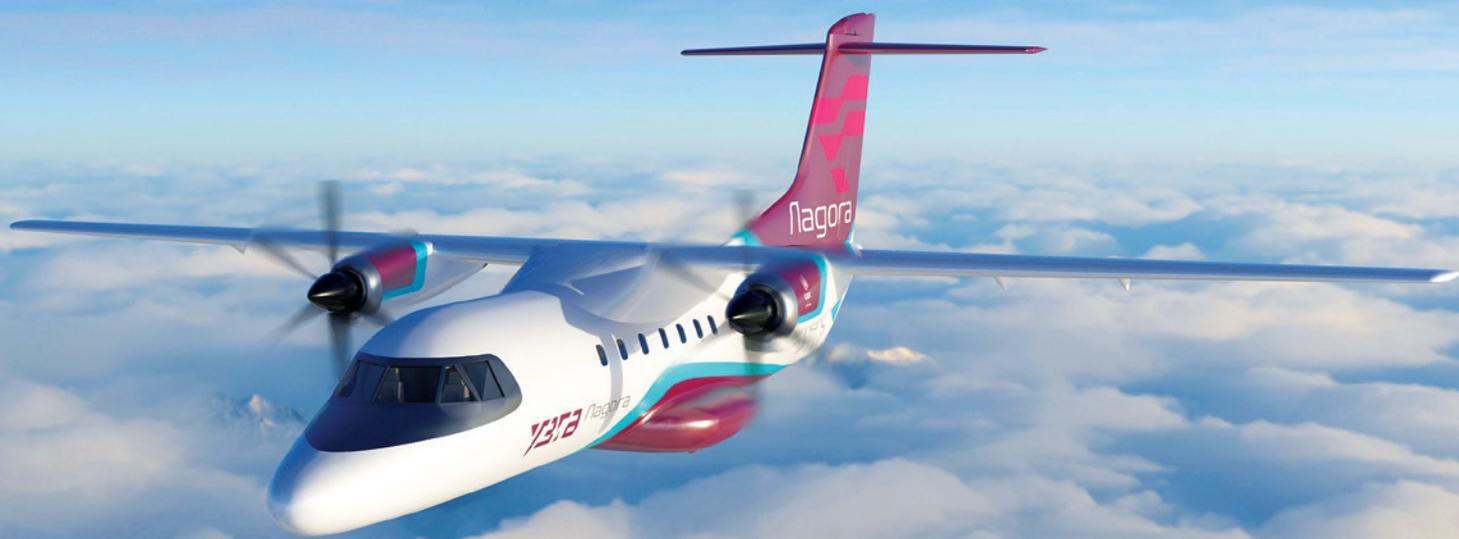
Самолет рассчитан на перевозку до 44 пассажиров. Может использоваться в комбинированном или грузовом варианте. Разработан с учетом возможности базирования на грунтовых аэродромах. Служит основой для разработки семейства самолетов, в том числе рамповой версии.
