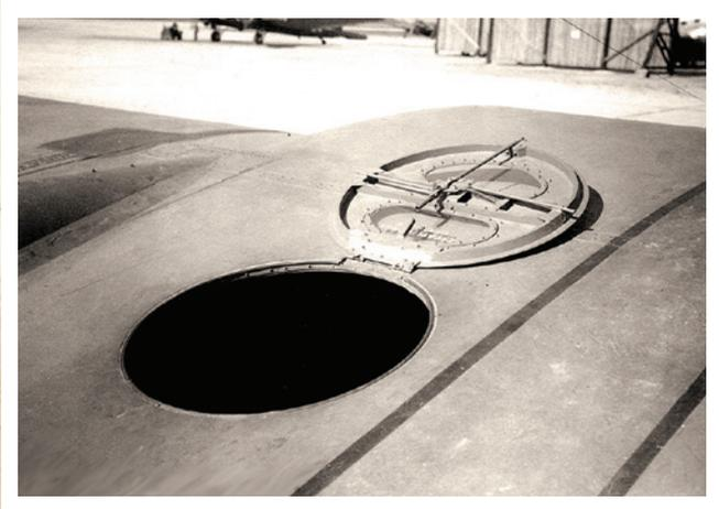
Аварийный люк в крыше грузового отсека
