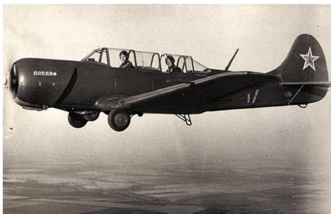
Самолёт Як-18Ас мотором AI-14P
