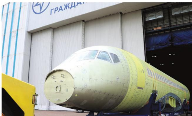
Фюзеляж SSJ-NEW на испытаниях в Жуковском
