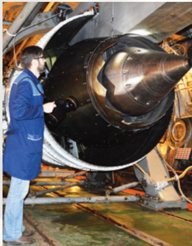
**Испытания двигателя ПД-14 на высотном стенде ЦИАМ**
