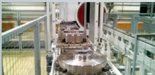
**Вакуумная термическая обработка заготовок**
