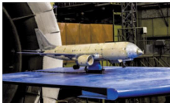
**Рис.6. Стенд для испытаний самолетов с моделированием реактивных струй ТРДД**
