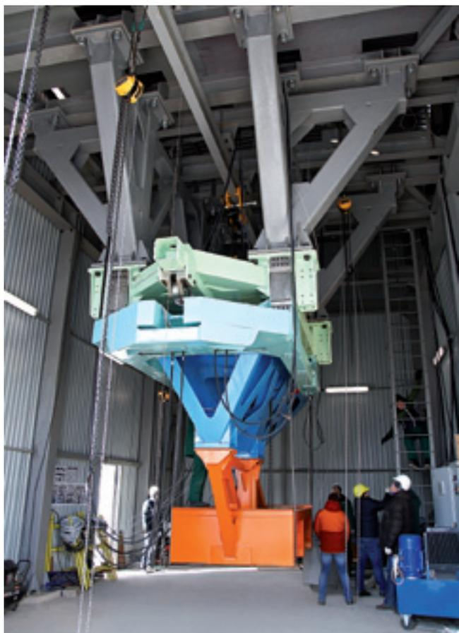
**Испытания макета СИС с имитатором двигателя в Цехе испытаний мехатроники ГК «МЕРА»**
