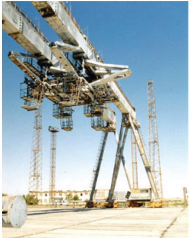
**Кран-погружатель грузоподъемностью 50 тонн (ПКУ-50). Пролет крана 60 м. Проект СКТБ-16. Космодром «Байконур»**
