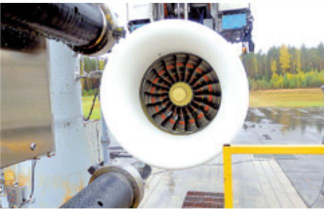
**Подготовка к испытаниям по забросу в двигатель ПД-14 посторонних предметов**
