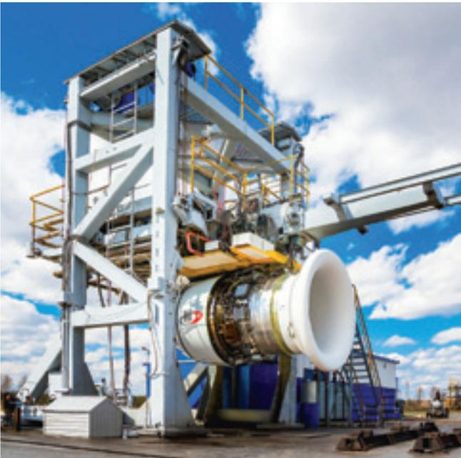
**Испытания двигателя ПД-14 на открытом стенде АО «ОДК-Авиадвигатель»**
