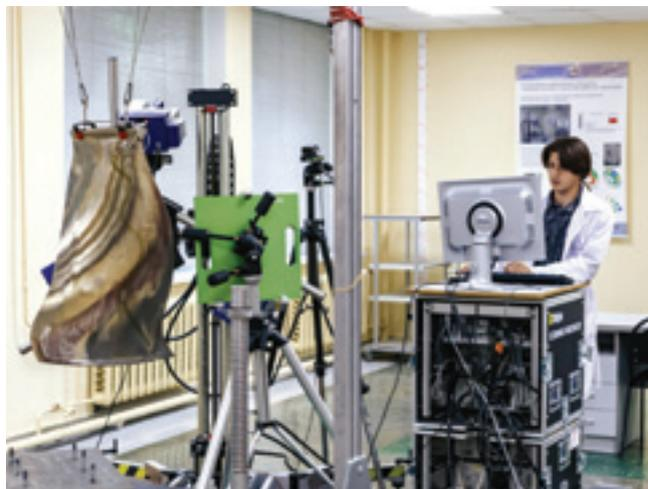
**Рис.5. В ходе исследований методом сканирующей лазерной виброметрии**
