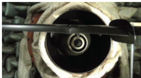
**Рис.8. Исследование шума взаимодействия струи двигателя с крылом самолета на стенде АК-2 ЦАГИ**
