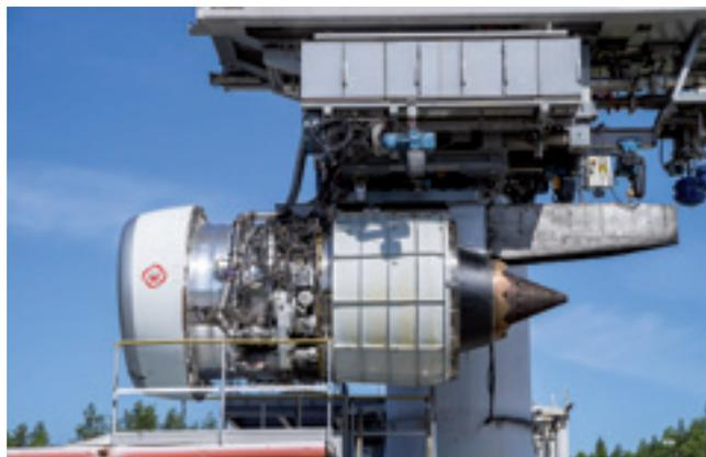
**Испытания двигателя ПД-14 на ОИС Полуево**
