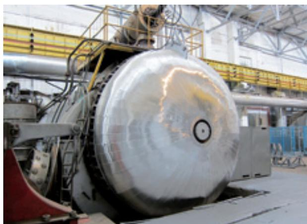
**Стенд испытания авиационных двигателей 5-го поколения ПД-14**
