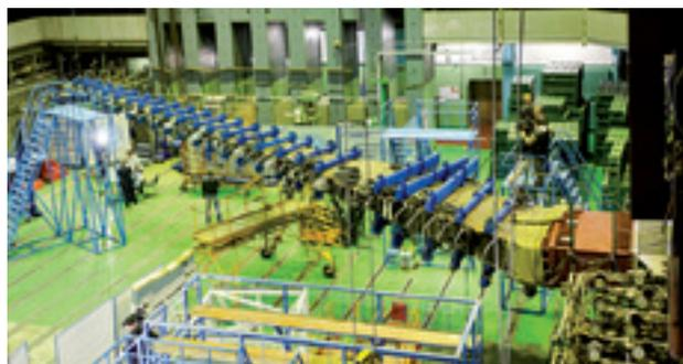
**Прочностные испытания кессона крыла из композитных материалов для МС-21**
