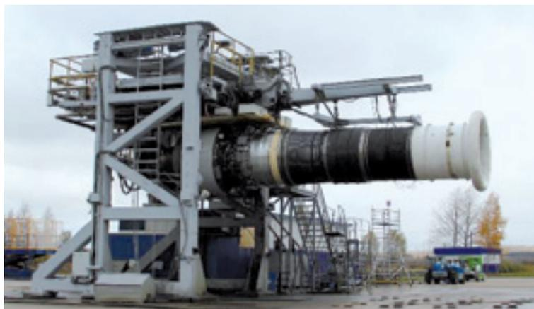
**Рис.7. Акустические измерения модального состава в стендовом воздухозаборнике на натурном двигательном стенде ОС-5**
