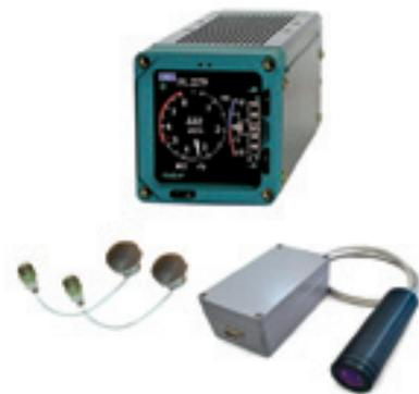
программно-аппаратную систему, предназначенную для измерения, вычисления и выдачи на индикацию экипажу и в бортовые системы информации о температуре воздуха, скорости и высоте полета летательного аппарата. Централизованная СВС,
