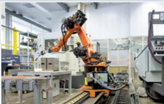
**Роботизированный комплекс без перерывов и простоев изготавливает образцы для прочностных испытаний**
