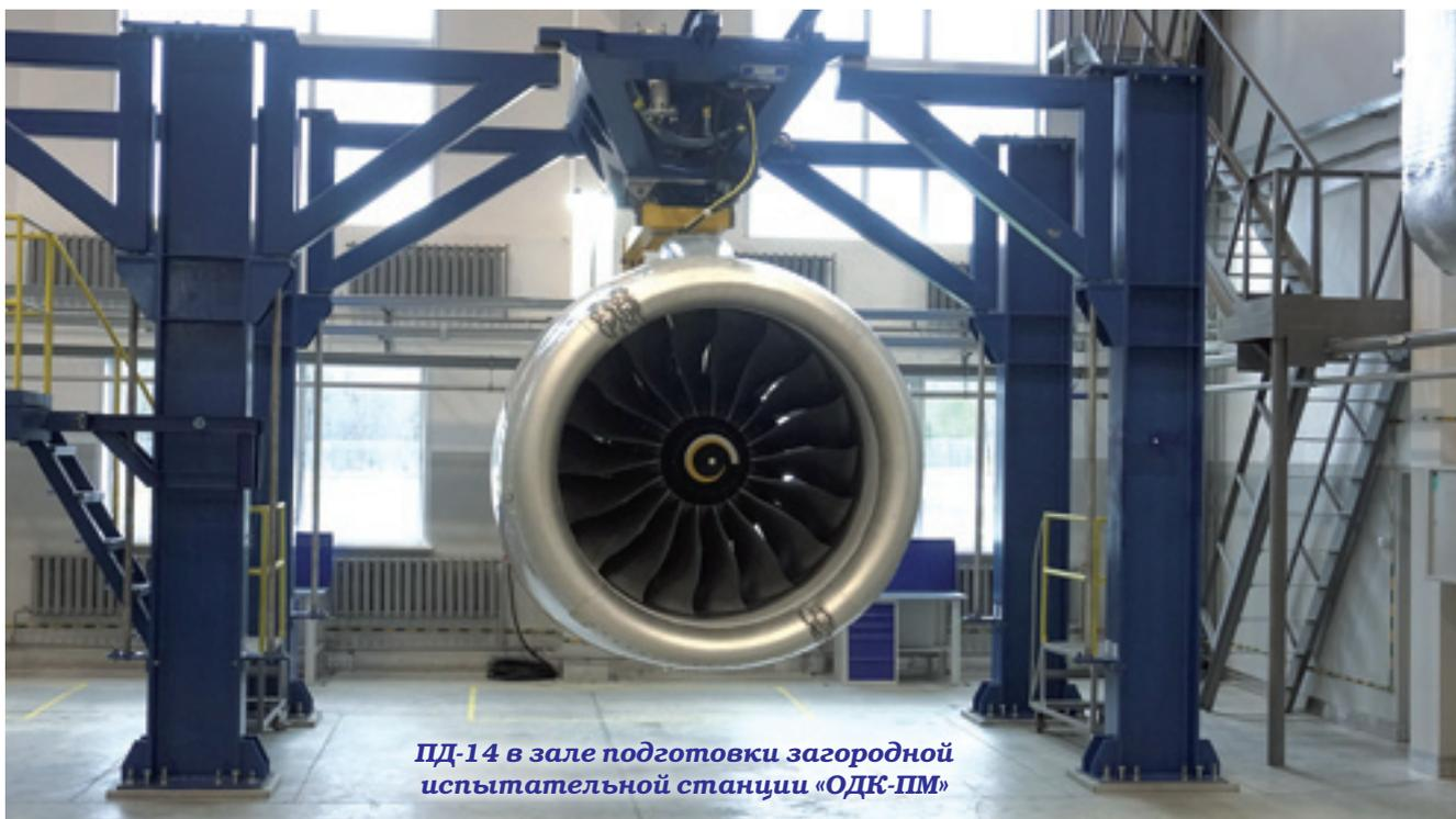
**ПД-14 в зале подготовки загородной испытательной станции «ОДК-ПМ»**
