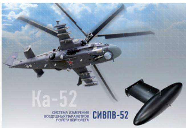
параметров вертолета СИВПВ-52, которую удобно компоновать на вертолетах с развитым крылом. Для корабельной версии Ка-52К «Катран» с укороченным крылом предприятие адаптировало алгоритм вычисления высотно-скоростных параметров.
