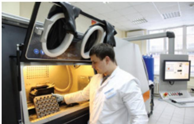
выращивают на установках электронно-лучевого синтеза из порошков, которые производят отдельно на специальном участке с применением бестигельной плавки сплава.
