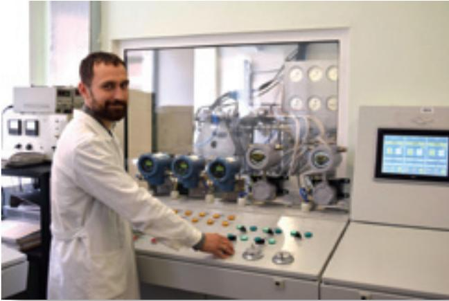
**Система управления двигателем ПД-14 проверена на воздействие внешних факторов - климатических и механических, на электромагнитную совместимость**
