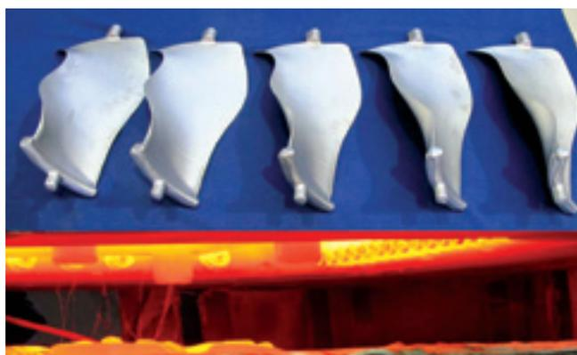
***Изотермическая штамповка лопатки вентилятора***
