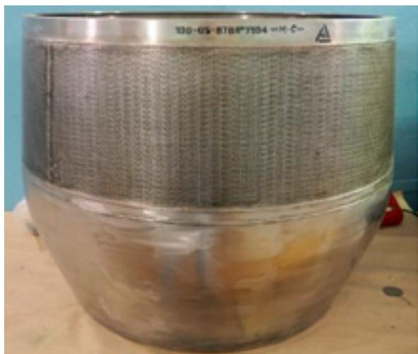
**Сопло внутреннее и центральное тело с элементами металлических звукопоглощающих конструкций (ЗПК) двигателя ПД-14**
