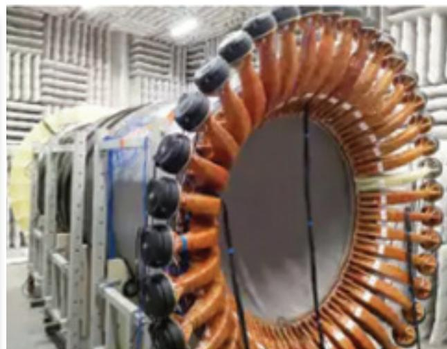
*Рис. 3. Элементы установки модального анализа шума в канале воздухозаборника*
