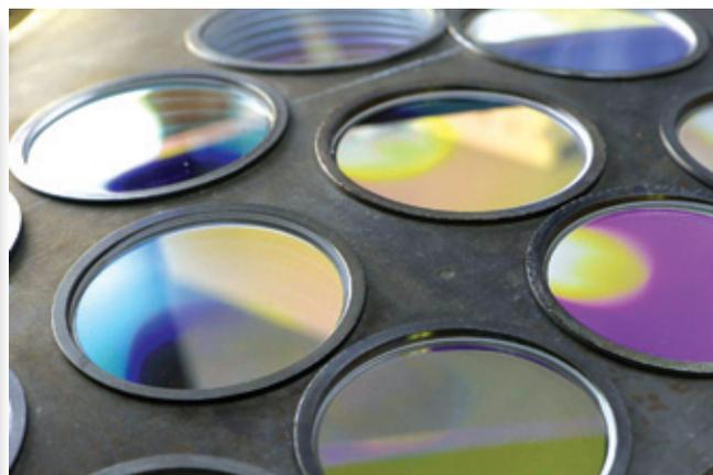
обнаружения и управления А-100 «Премьер». Благодаря специально разработанному составу и технологии магнетронного напыления удалось не только решить задачу экранирования кабины, но и повысить светопропускаемость стекол кабины пилота до 65-70%. На предыдущем поколении летающих радаров этот показатель не превышал 30%.
