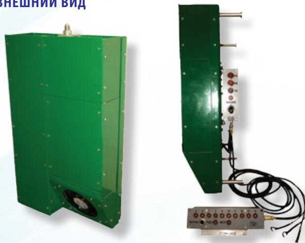
Конструктивно, анализатор «Поток-365» представляет собой панель, размещаемую на боковой поверхности агрегата и имеющую штуцеры для подключения к гидравлической магистрали. На вынесенной индикаторной панели располагаются индикаторы, которые соответствуют классу чистоты контролируемой жидкости от 5 до 14 класса в соответствии с ГОСТ 17216-2001.
