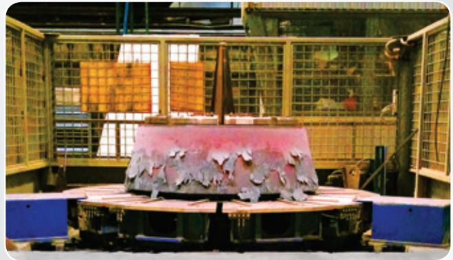
**Процесс экспандирования кольцевой заготовки «Корпус силовой турбины»**
