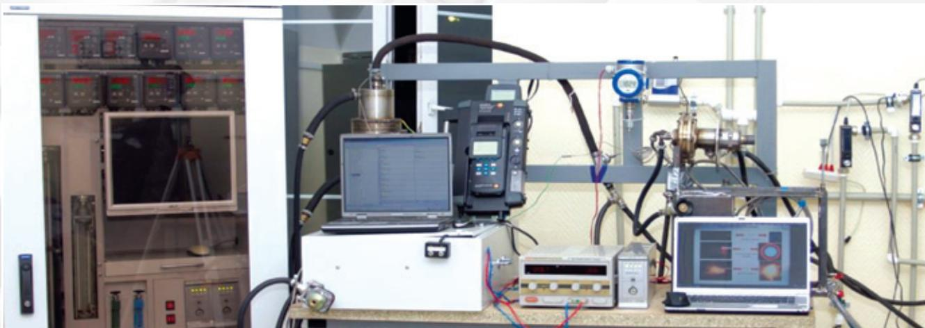
**Рисунок 2. Комплекс производства и сжигания водородосодержащего синтез-газа из ПНГ**
