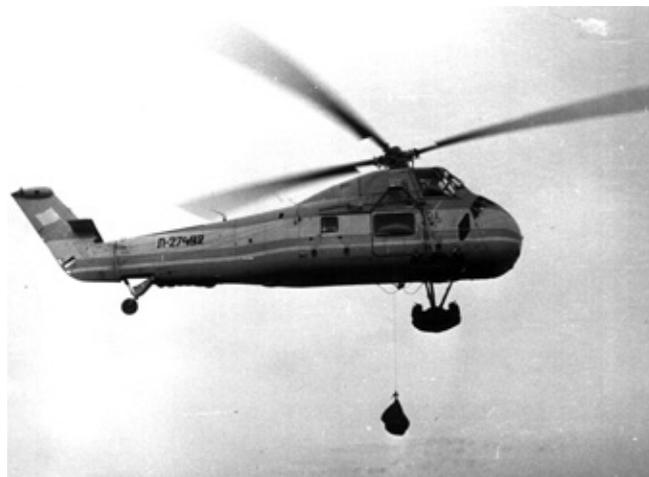
*Фото из отчёта ОКБ им. М.Л.Миля по испытаниям на S-58 гидролебёдки VL-1315 для подъёма на борт человека или грузов*
