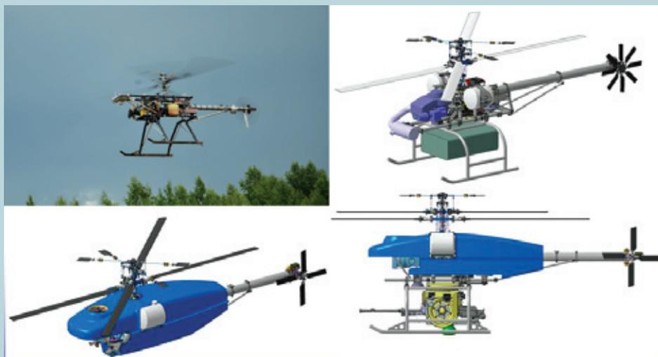
Сменные модули полезной нагрузки
