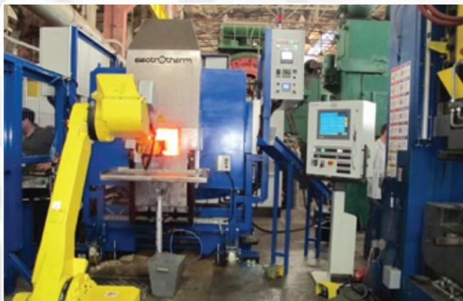
**Рисунок 3. Проект по автоматизации производства: РТК штамповки лопаток компрессора ГТД\*\***
