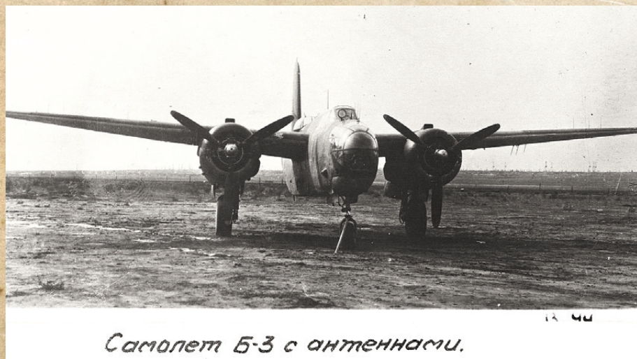
Этот ночной истребитель Douglas DB-7 (у нас его называли Б-3, т.е. Boston III) оснащён РЛС «Гнейс», антенны которой видны на крыле сверху и снизу
