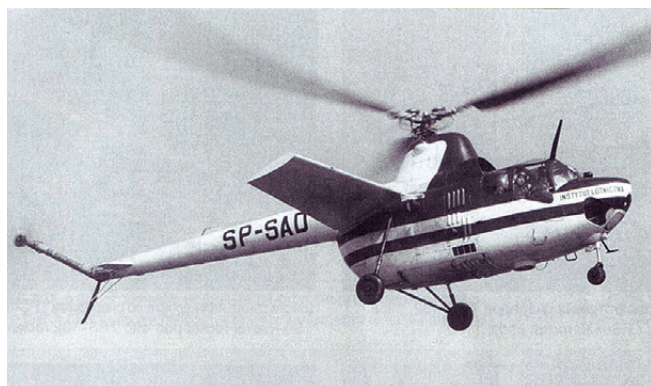
SM-1-300 – Ми-1 польской постройки (в экспериментах с крылом)
