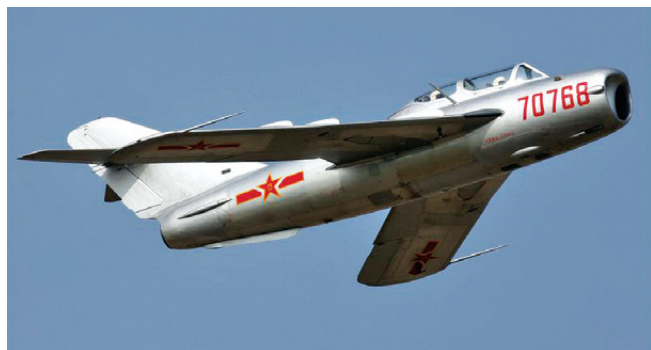
JJ-5 – китайский аналог УТИ МиГ-15, но на базе самолёта МиГ-17Ф (J-5)
