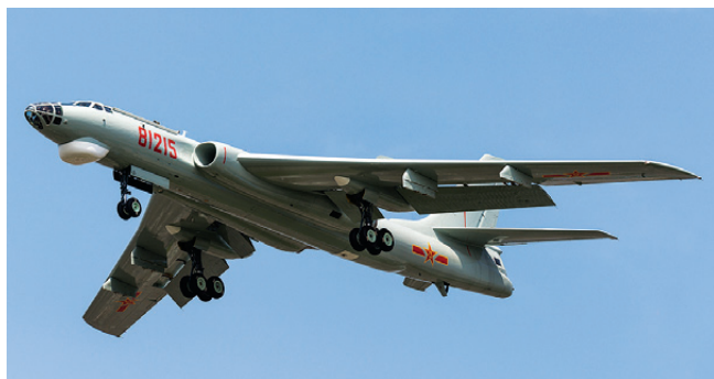
Один из вариантов самолёта Xian H-6, созданных в КНР на базе советского Ту-16
