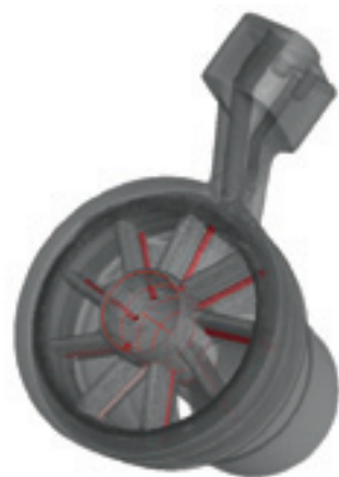
Рис. 5. Горелочное устройство, произведенное методом аддитивных технологий
