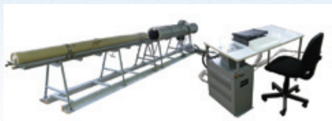
Базовый комплект контрольно-проверочной аппаратуры 9В684-Е для контроля ЗУР ЗРПК «Панцирь-С1»
