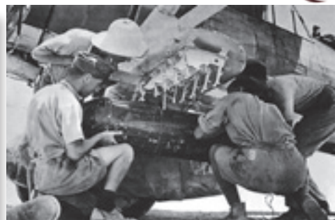
Подвеска контейнера SBC тип М для зажигательных бомб под крылышко самолёта «Лайсендер». Фото: Life
