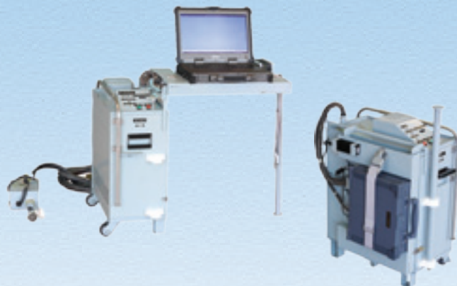
Контрольно-проверочная аппаратура 9В9002 для проверки ракет РСЗО (в рабочем положении и в свернутом виде для перемещения)
