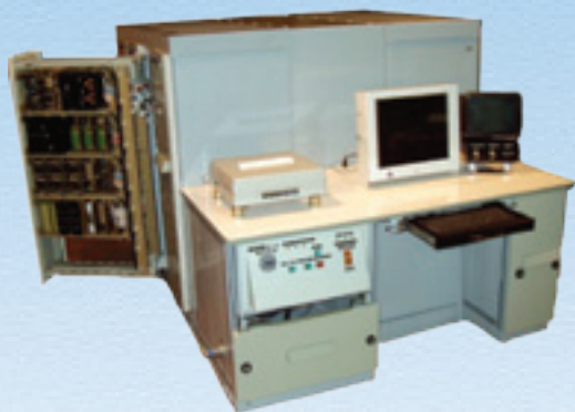
Комплекс подготовки авиационных средств поражения «Ока-Э-1»
