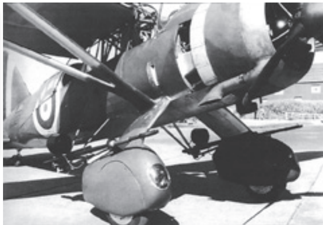
«Лайсендер» с экспериментальной подвеской пушек Эрликон
