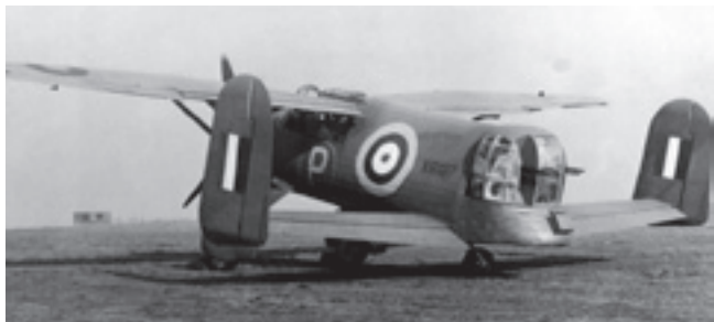
«Лайсендер», с цельноповоротной стрелковой башней «Фрээр-Нэш» (опытный вариант Р.12)
