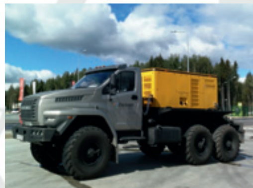
Дизельные комбинированные источники 400Гц, 28,5 В, 50Гц
