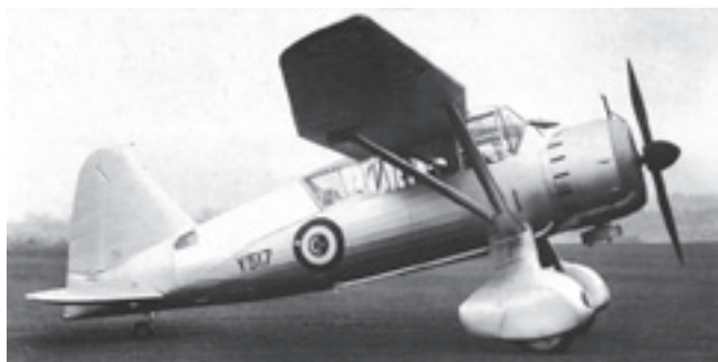
«Лайсендер» Mk I египетских ВВС, осень 1938 г. Обратите внимание на противопопыльный фильтр «Воукс» под капотом и на штангу для подъёма грузов с земли, уложенную вдоль фюзеляжа, снизу
