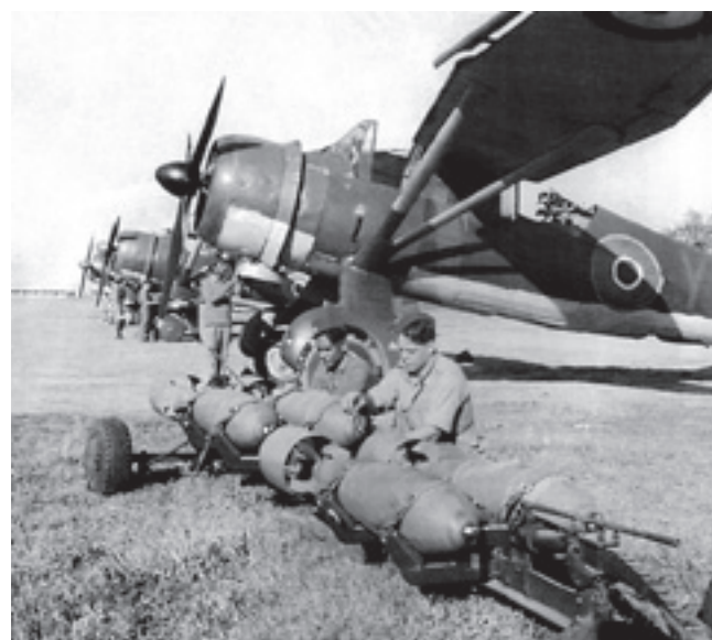
«Лайсендер» Mk II из 45 эскадрильи, вооружаются 113,5 – килограммовыми бомбами
