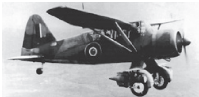
В полёте «Лайсендер» с оборудованием для постановки дымовых завес
