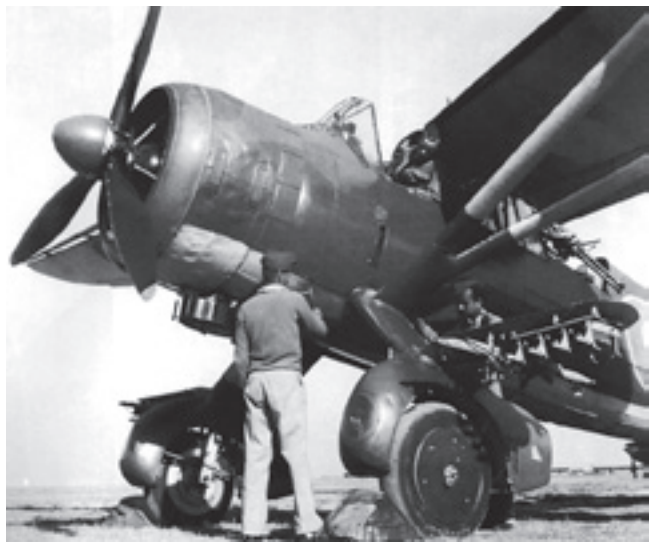
Подготовка к полёту «Лайсендера» Mk II из 4-го индийского дивизиона. Панели с обтекателей колёс сняты. На самолёте установлен противопопыльный фильтр и спаренный пулёмёт Браунинг
