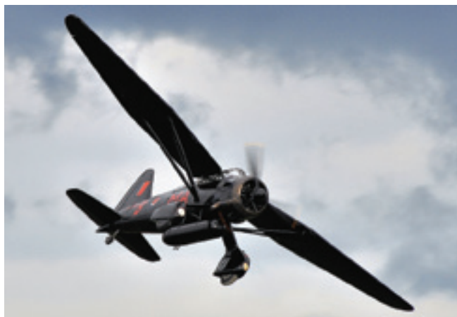
«Лайсендер» Mk III (SD), с подвесным баком на 682 л. Самолёт окрашен для ночных действий. Современное фото
