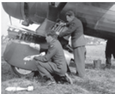
«Лайсендер» из 110 Армейской вспомогательной эскадрильи снаряжается 5,2 кг бомбами и патронами к пулемёту
