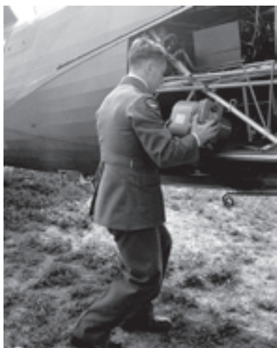
Установка аэрофотоаппарата на самолёт «Лайсендер»
