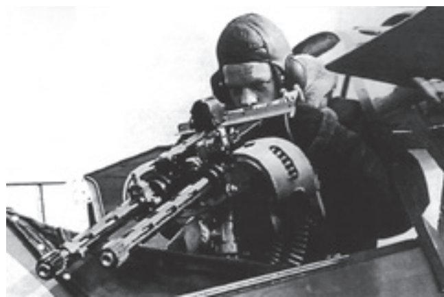
Спаренный пулемёт Браунинг устанавливался на самолёты «Лайсендер» Mk III Mk и IIIA
