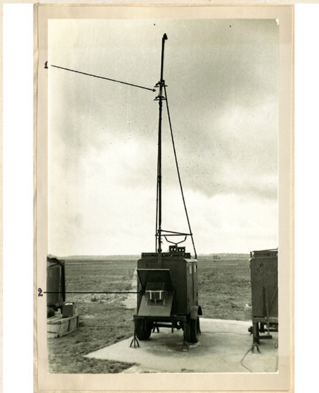
Фото № 6. УКВ глиссадный радиомаяк ГРМ-1 / "Кипарис" /. 1. Верхняя антенна. 2. Нижняя антенна.
