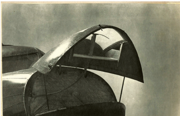
Размещение внутрифюзеляжной антенны на самолете Ли-2.
