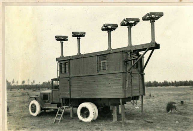
Установка курсового радиомаяка КРИ-1 /«Клён-П»/ на автомашине.
