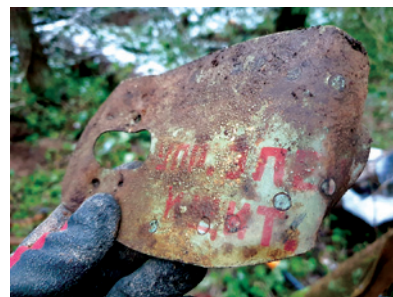
Лючок с нижней консоли крыла самолета Пе-2
