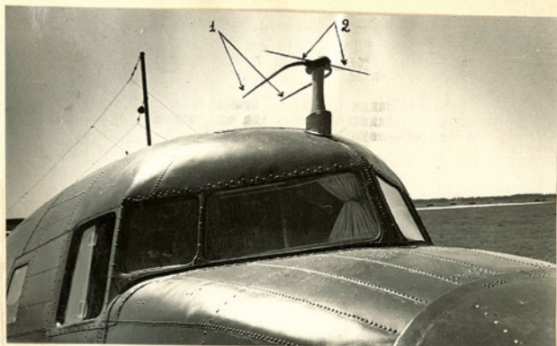
Фото № 93. Установка комбинированной антенны для курсового и глissадного приемников. 1. антенна курсового приемника. 2. антенна глissадного приемника.
