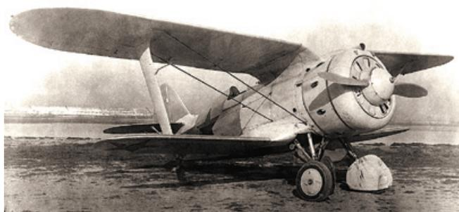
Самолет И-153 «Чайка» с автоматическим винтом АВ-1
