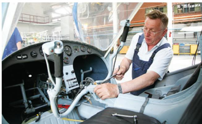
Монтаж систем управления сверхлёгкого самолета МАИ-890 «Авиатика»
