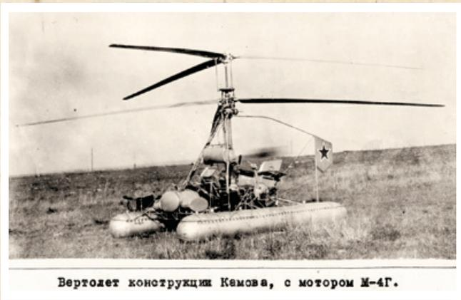
Вертолет конструкции Камова, с мотором М-4Г.
