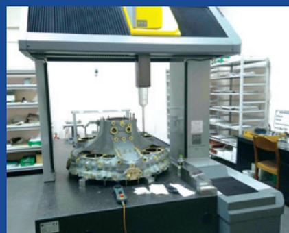
Контроль изготовленных корпусных деталей с использованием измерительной машины
