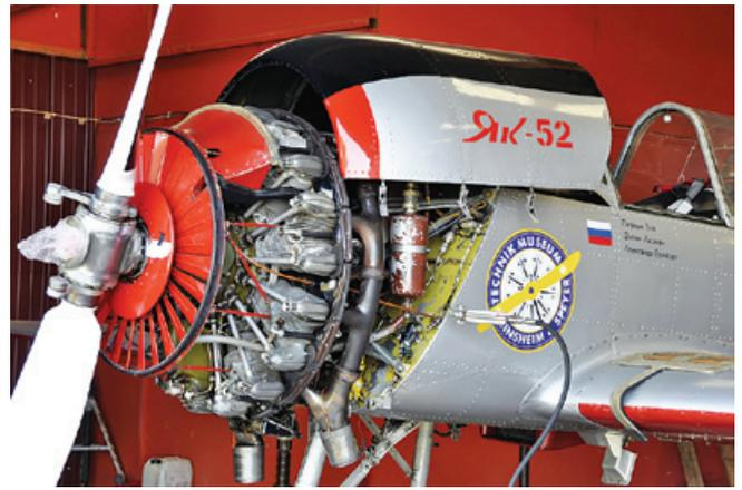
Раскапотированный мотор М-14П на Як-52
