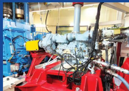
Серийный образец редуктора во время приемочных испытаний
