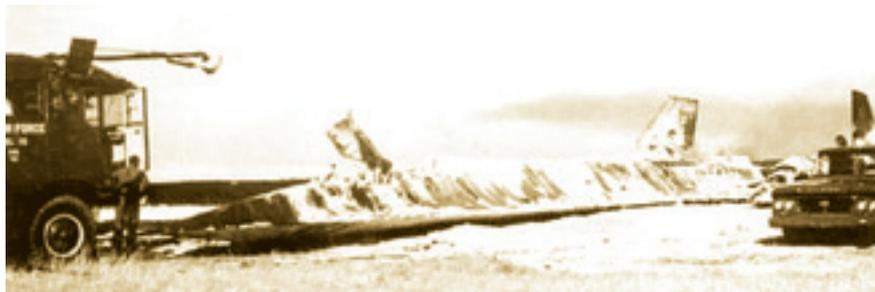
**SR-71A (61-17977) потерпел аварию на авиабазе Бил (Beale). На посадке у самолета заклинило тормоза, пневматики загорелись и подожгли топливо, которое вечно капало из баков SR-71. Пилоты остались живы**
