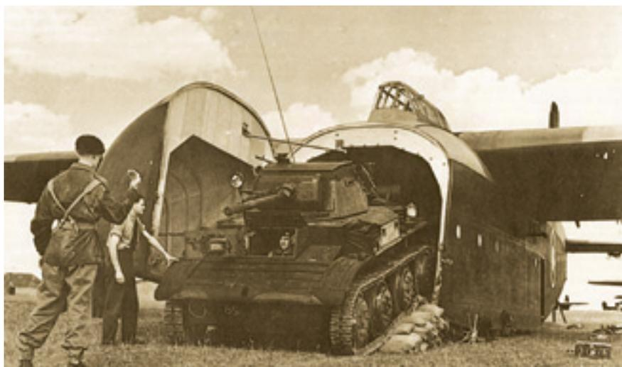
**Примерка танка Тетрарх к прототипу планера Хамилькар. На планере отсутствует колёсное шасси и основание фонаря сделано коротким, заподлицо с лобовым стеклом. Чтобы не проломить первый шпангоут, из мешков с песком сделан пандус.**
