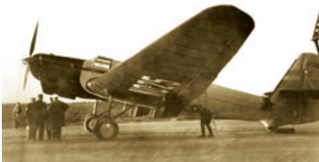
тели по массам: полетная масса 11250 кг, масса пустого - 4200 кг, масса топлива и масла - 6230 кг, масса полезной нагрузки - 820 кг, эти параметры должны были обеспечить достижение необходимой дальности полета.
