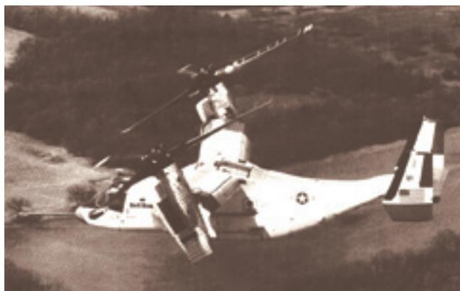
**Прототип V-22 в полёте. На мотогондолах, крыле и верхней части планера наклеены ворсинки для визуализации потока. В носу фюзеляжа установлена штанга с приборами. На конвектоплане установлен иллюминатор под фонарем кабины большого размера, который в серии был уменьшен. Створка основного шасси в серии также была изменена**
