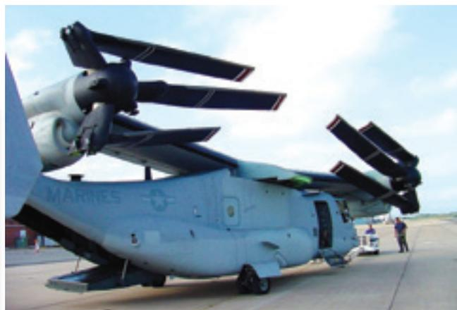
*«Оспри» в сложенном состоянии. Удивительно то, что «свернуться» он может автоматически, от нажатия одной кнопки, всего за 1,5 минуты. Двухкилевое оперение было выбрано для уменьшения габаритов в свёрнутом положении*
