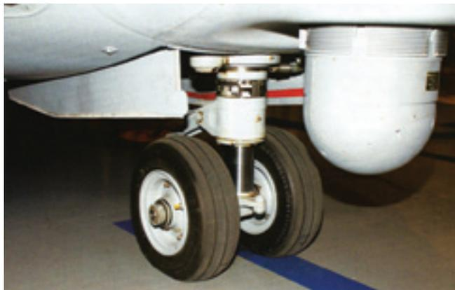
**Турель системы FLIR и передняя опора шасси**
