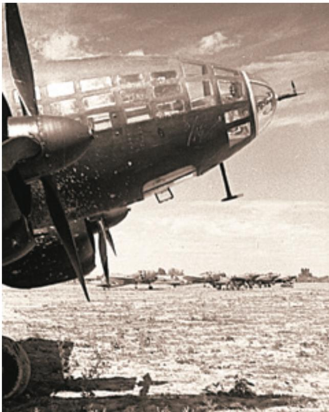
**В носовой оборонительной установке Ил-4 монтировался пулемет ШКАС**
