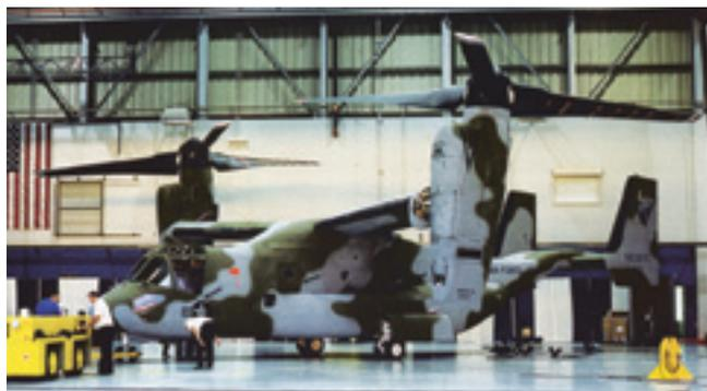
**Один из прототипов V-22. Конвертоплан покрашен в камуфляж и имеет обозначения ВВС США. От серийных аппаратов он отличается отсутствием аэродинамических грешней на фюзеляже и крыле, большим иллюминатором под фонарём и большой створкой основной стойки шасси. Конструкция кока винта также будет изменена**
