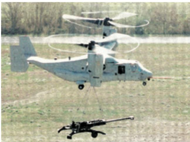
**Транспортировка пушки LW 155 мм, весом 4223 кг, на внешней подвеске. Груз подвешен на задний крюк. Испытательный полёт в мае 1999 г.**
