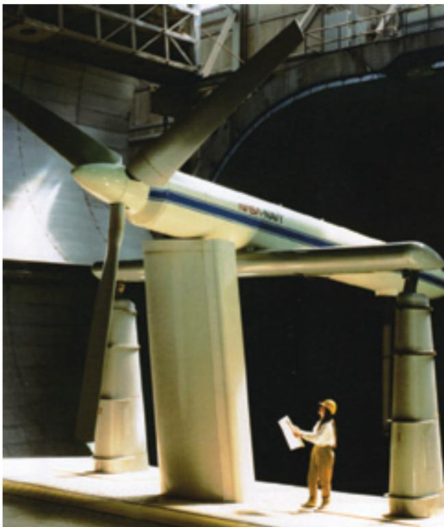
**Создание ротора для такого инновационного аппарата, как конвертоплан, является сложнейшей инженерной задачей. Здесь ротор, в масштабе 2/3 от оригинала, исследуется в аэродинамической трубе**
