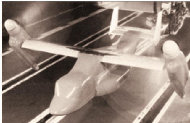
*Продувка одной из моделей JVX в аэродинамической трубе фирмы «Боинг Вертол»*
