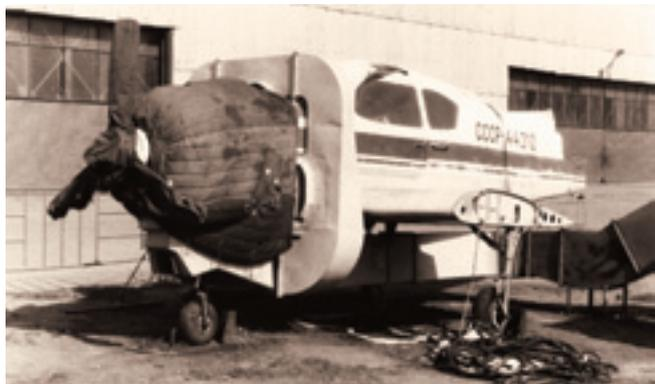
**Як-18Т СССР-44310 как стенд для испытания силовой установки самолёта «Молния-1»**
