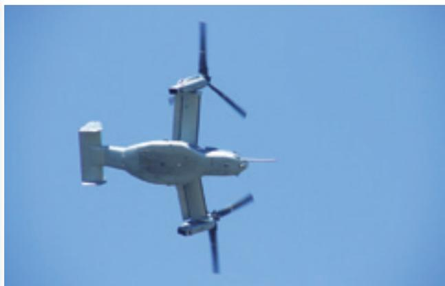
**«Оспри» в полёте. Шасси убрано, проводится конвертация к горизонтальному полёту**
