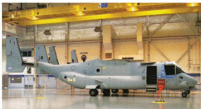
*Фюзеляж серийной машины № 44 в сборочном цехе. Видна боковая входная дверь. Над ней – аэродинамический гребень. На крыше фюзеляжа виден погон для установки и поворота крыла*
