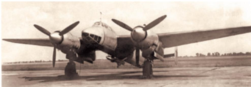
*Ту-2 с подвешенной под фюзеляжем моделью для аэродинамических исследований*
