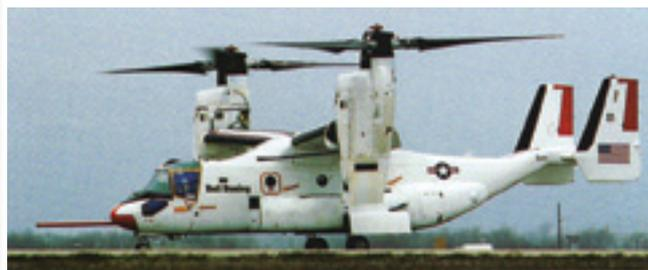
**Первый прототип V-22 «Оспри». Для удобства отработки сняты обтекатели с узлов складывания лопастей и передний обтекатель кока**
