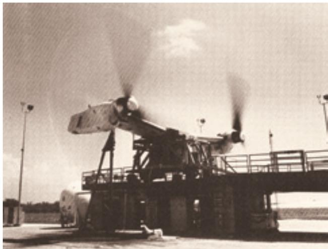
**Отработка силовой установки V-22 «Оспри» на наземном стенде фирмы Белл**
