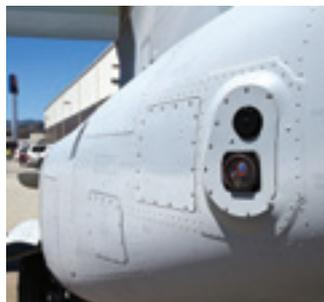
*Сенсоры обнаружения РЛС и лазерного облучения, установленные на спонсоне*
