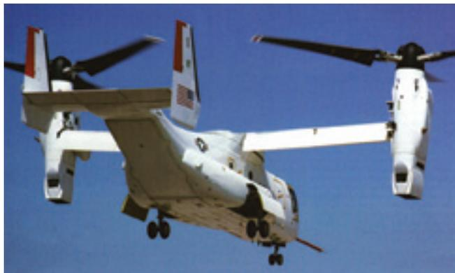
**Первый прототип в полёте. Видно, что хвостовая рампа выполнена цельной. В серии она состояла из двух частей**
