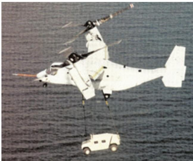
**Во время испытаний, с частично выпущенными флапперонами, «Оспри» нёс на внешней подвеске автомобиль Хамвей, (2855 кг) со скоростью 240 км/ч. Груз подвешен на оба крюка. Во время одного из полётов лопнуло лобовое стекло Хамвея**
