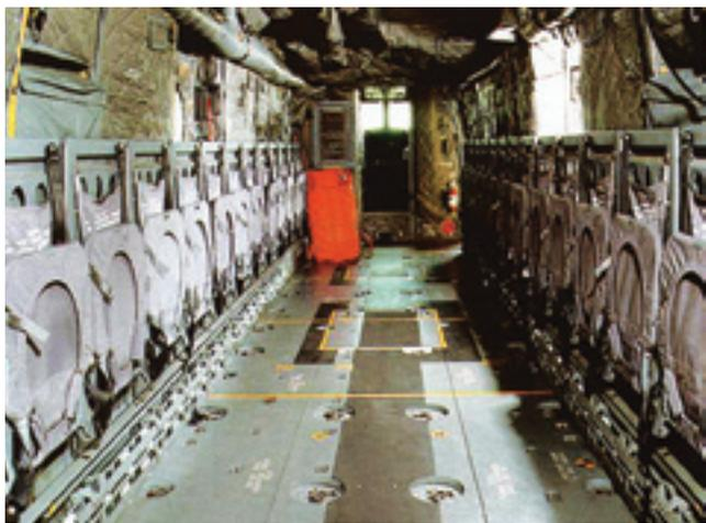
**В грузовой кабине по бортам расположены откидные сиденья для десантников. На полу видны кольца для швартовки грузов и люки доступа к крюкам наружной подвески. Слева от двери пилотской кабины – упакованный спасательный плот**
