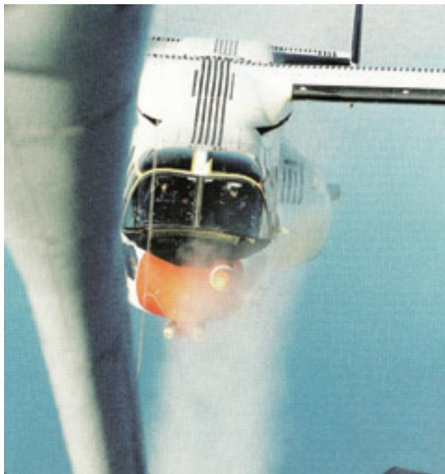
**Прототип №2 во время отработки противообледенительной системы. Вода разбрызгивается из заправщика КС-135. Противообледенительная система «Оспри» - не самая сильная сторона конвертоплана. Из-за её слабости в Афганистане «Оспри» часто не может летать на высотах, больших чем 3000 м**
