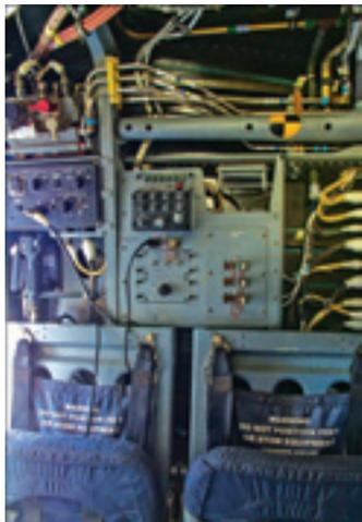
**Щитки управления оборудованием грузовой кабины**
