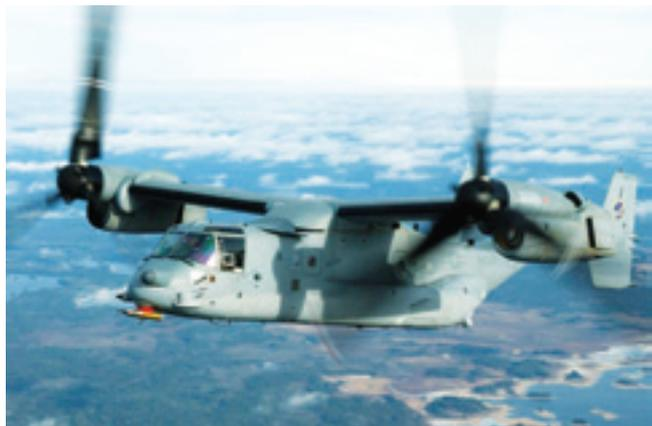
*На этом V-22 установлена экспериментальная пулемётная установка, кал. 7,62 мм*
