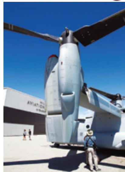
**Мотогондола. Смеситель выхлопных газов и наружного воздуха сопоставим по размерам с человеком. На торце флаперона виден профилированный рельс, обеспечивающий нужный закон выпуска флаперона**
