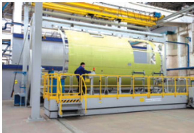
Первые компоненты самолета МС-21 на станции новой сборочной линии
