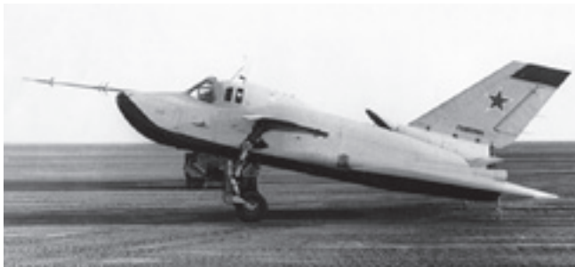
Аналог «105.11» с колесным шасси на грунтовой полосе ГКНИИ ВВС
