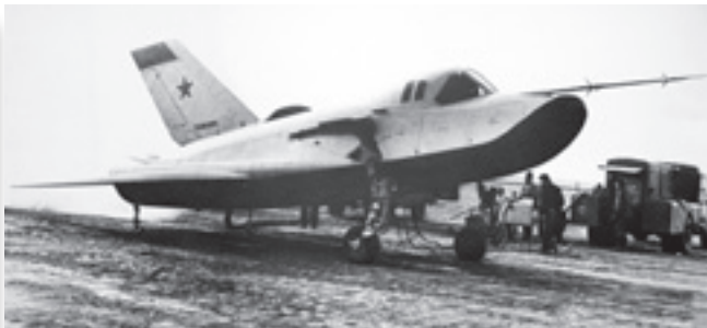
Проверка работоспособности силовой установки аналога «105.11»
