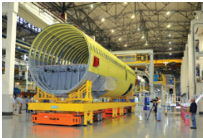
Полуфюзеляж MC-21 на автоматизированной тележке
