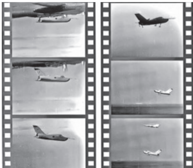
Кадры рабочего фильма, иллюстрирующие процесс отцепки от носителя и заход «105.11» на посадку на лыжном шасси
