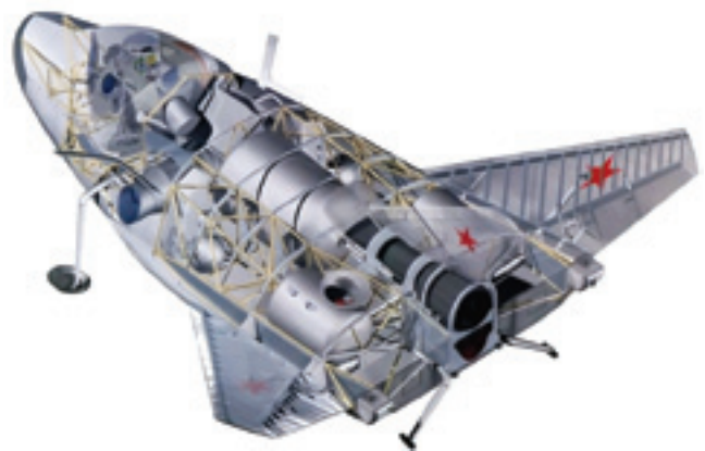
Внутреннее устройство воздушно-орбитального самолета в варианте фоторазведчика
