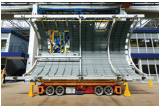
Панель фюзеляжа самолета МС-21 на станции новой сборочной линии
