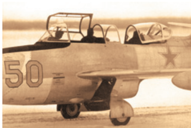
Як-23УТИ/II борт 50 доработанный с гранёным козырьком передней кабины и разделительной секцией между кабинами (два снимка)
