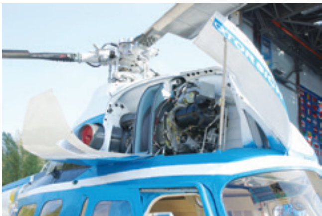
Ми-2МСБ: силовая установка и новая дверь кабины
