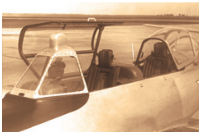
Як-23УТИ в его последнем варианте – с закрытыми (вверху) и открытыми (внизу) крышками кабин
