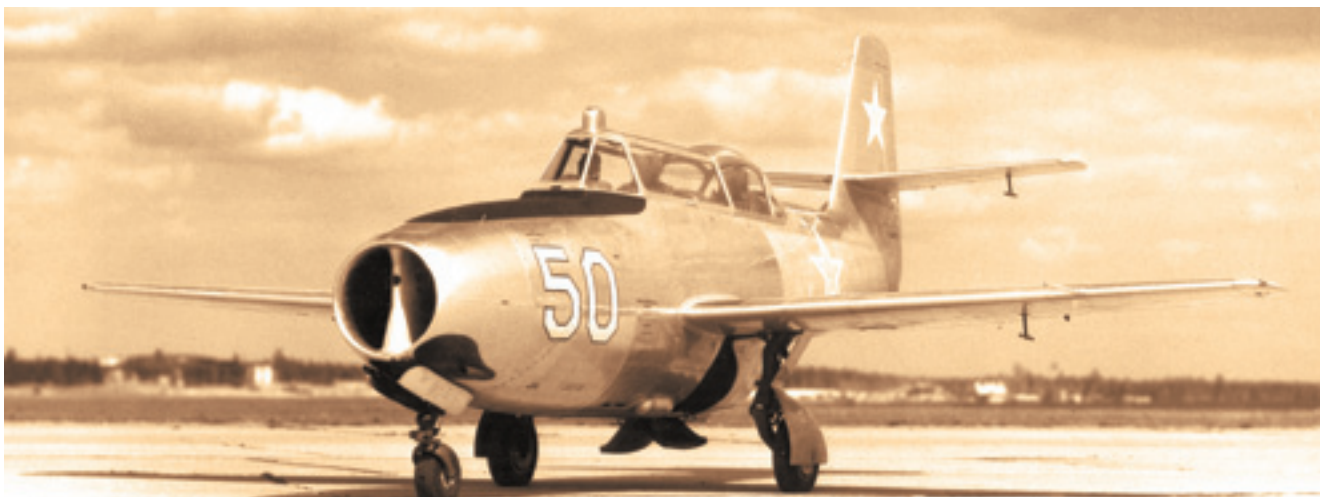
Як-23УТИ/П борт 50 в своей последней конфигурации с новой выпуклой крышкой задней кабины и фотопулемётом С-13 на месте фары в носовой перегородке
