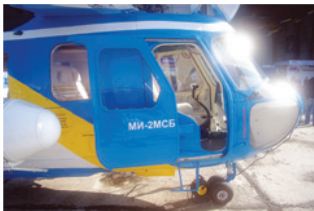
Ми-2МСБ: силовая установка и новая дверь кабины
