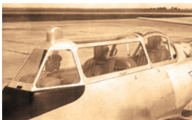
Як-23УТИ/П борт 50 в своей последней конфигурации с новой выпуклой крышкой задней кабины и фотопулемётом С-13 на месте фары в носовой перегородке
