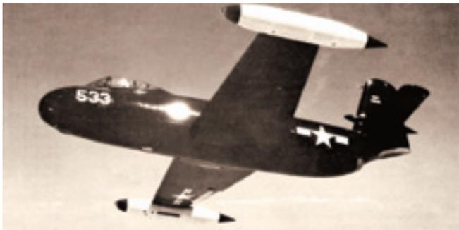
**Второй прототип XF6U-1 с подвесными баками. На киле установлен торпедообразный обтекатель**
