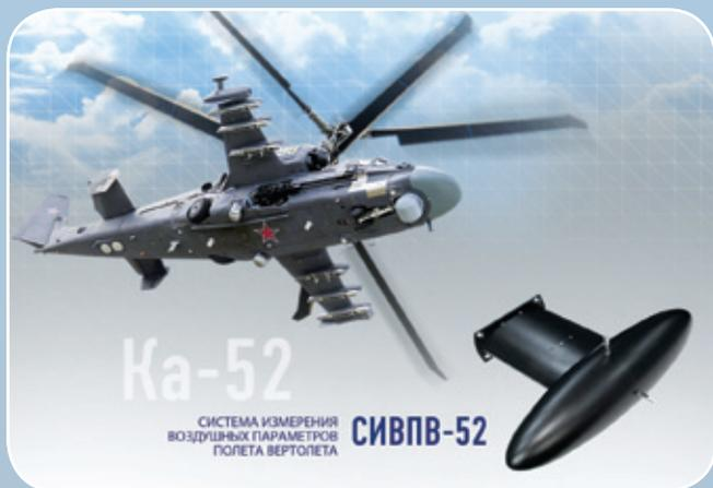
Система состоит из двух функционально законченных модулей (МИВП). Модуль включает в себя два ПВД, блок контроля обогрева ПВД, блок датчиков давления, датчики температуры наружного воздуха, вычислитель воздушных параметров полета и источник питания.
