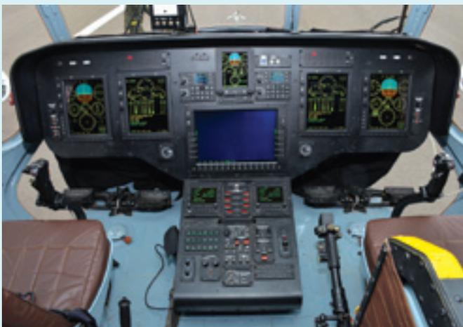
**Приборная панель вертолета Ми-171А2 с комплексом бортового оборудования КБО-17-1 разработки АО «УКБП»**
