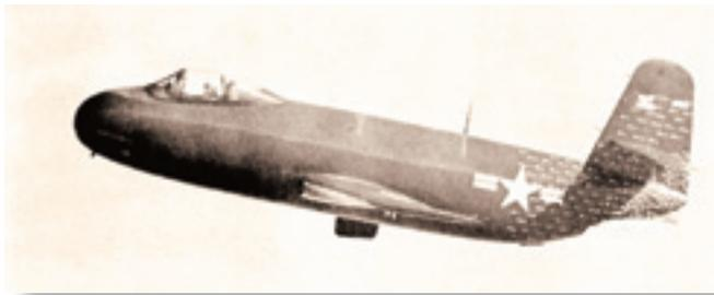
**Летные испытания XF6U-1. Хвостовая часть оклеена полосками ткани для исследования особенностей обтекания**
