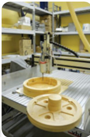
**Станок с ЧПУ для изготовления модельной оснастки**
