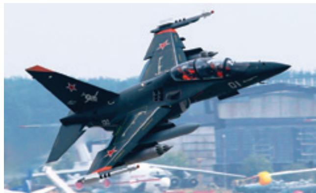
**Серийный Як-130. Обратите внимание на дополнительные воздухозаборники на верхней поверхности наплыва и на «клык» на передней кромке стабилизатора. В итальянской машине эти элементы отсутствуют**
