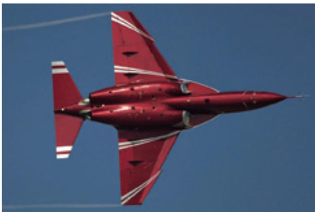
**Третий прототип (так называемый красный прототип) с серийным номером СРХ617 (заводской номер - 6964/003). Это первый предсерийный самолёт, обозначенный как LRIP 00 (Low Rate Initial Production). Самолёт имел полный состав пилотажно-навигационного оборудования и возможность перепрограммирования системы управления. Самолёт соответствовал стандарту для серийных машин**
