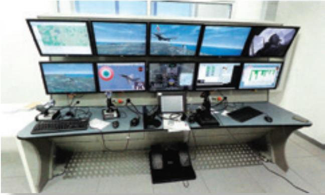
**Учебно-тренировочный комплекс ITS состоит из воздушной ETTS (Embedded Tactical Training System) системы и наземной тренировочной базы GBTS (Ground Based Training System)**
