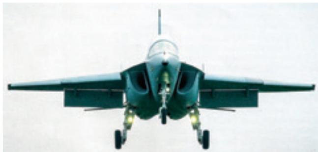
**Самолёт имеет трапецевидные крылья полумонококовой конструкции. Возле фюзеляжа имеется напльв, который генерирует вихри, улучшающие обтекание во время маневрирования. Механизация состоит из отклоняемого носка и посадочного закрылка**
