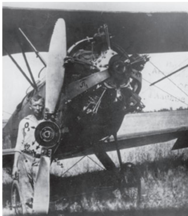
**У-2 со снятым винтом-глушителем. Видна задняя сторона его втулки**
