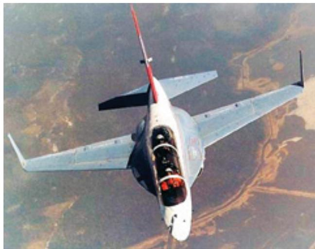
**Самолёт-демонстратор Як-130Д в первоначальной конфигурации. Самолёт имеет «утиный» нос и крылышки на законцовках крыла**
