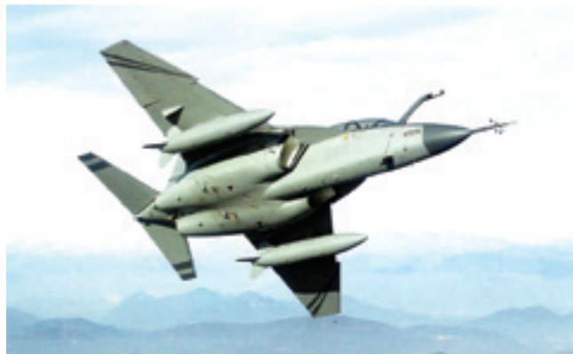
**Второй прототип (так называемый серый прототип) с серийным номером СРХ616 (заводской номер - 6963/002) в конфигурации для перегоночного полёта, с двумя подвесными баками по 630 л и штангой для дозаправки в воздухе**
