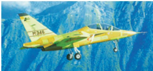
**Первый прототип M-346 Master, серийный номер СРХ615 (заводской - 6962/001) во время одного из испытательных полётов. Ещё не окрашен. Агрегаты из алюминиевых сплавов и композиционных материалов имеют разный цвет грунтовки**
