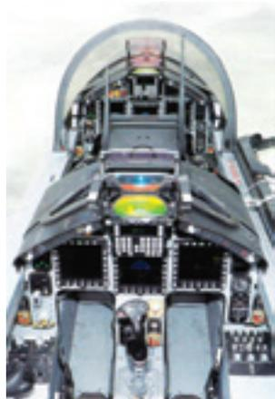
**Кабины самолёта М-346 Master оснащены многофункциональными дисплеями MFD, в обеих кабинах установлены также дисплеи переднего обзора HUD**
