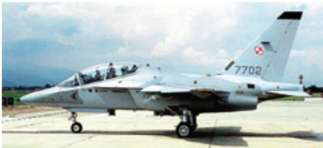
**Аэродинамическая схема самолёта - классическая со стреловидным крылом с корневыми напльвами. Оперение - классическое однокилевое, стреловидное. Между напльвом и крылом расположен аэродинамический гребень**
