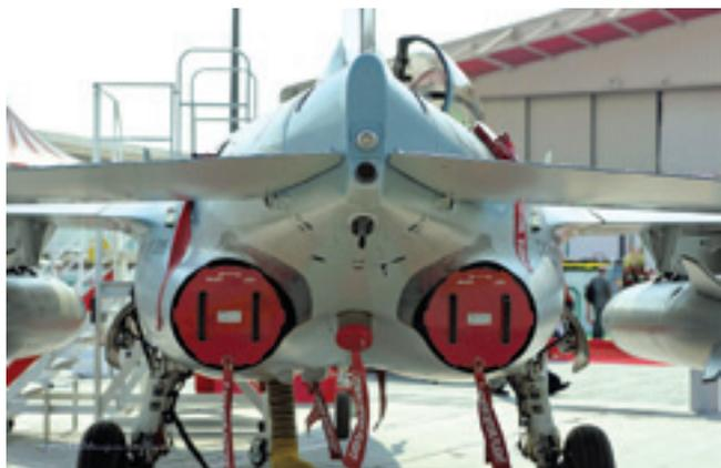
***М-346, вид сзади, видны сопла двигателей Honeywell-ITEC F124-GA-200, между ними, сверху, выхлопное сопло вспомогательной силовой установки SNECMA Rubis 3***
