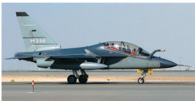
**Второй прототип M-346 располагает возможностью перепрограммирования настроек системы управления в соответствии с характеристиками конкретных боевых самолётов**
