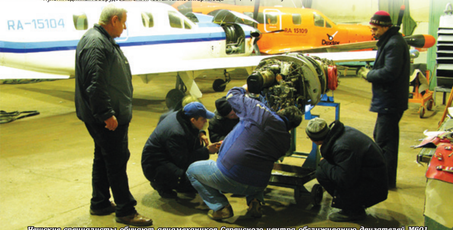
Чешские специалисты обучают авиамехаников Сервисного центра обслуживанию двигателей M601
