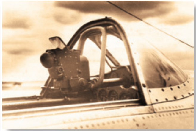
Выдвижная установка прицела АСП-3Н на Як-23 № 3123101. Прицел в убранном (слева) и выдвинутом (справа) положении
