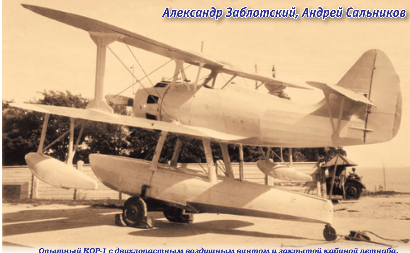
Опытный КОР-1 с двухлопастным воздушным винтом и закрытой кабиной летнаба. Таганрог, завод N 31, 1936 г.
