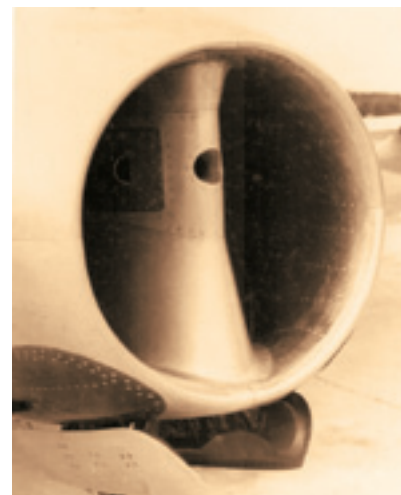
Первый серийный Як-23 борт 01, №3123101, на КИ в ГК НИИ ВВС. Справа – установка фотопулемёта С-13 на месте фары на этом экземпляре Як-23
