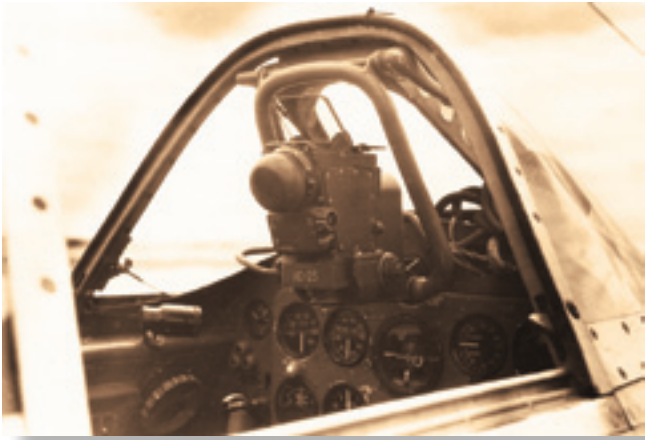
Выдвижная установка прицела АСП-3Н на Як-23 № 3123101. Прицел в убранном (слева) и выдвинутом (справа) положении
