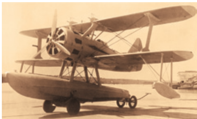
Опытный КОР-1 на перекатном шасси. Госиспытания, Севастополь, май 1937 г.
