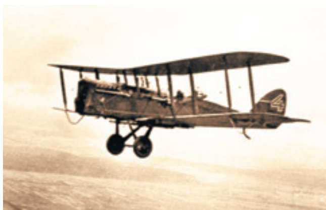
Самолет-разведчик Р-1 в полете. Машина вооружалась двумя пулеметами и могла нести до четырех авиабомб АФ-82 (пятипудовых)
