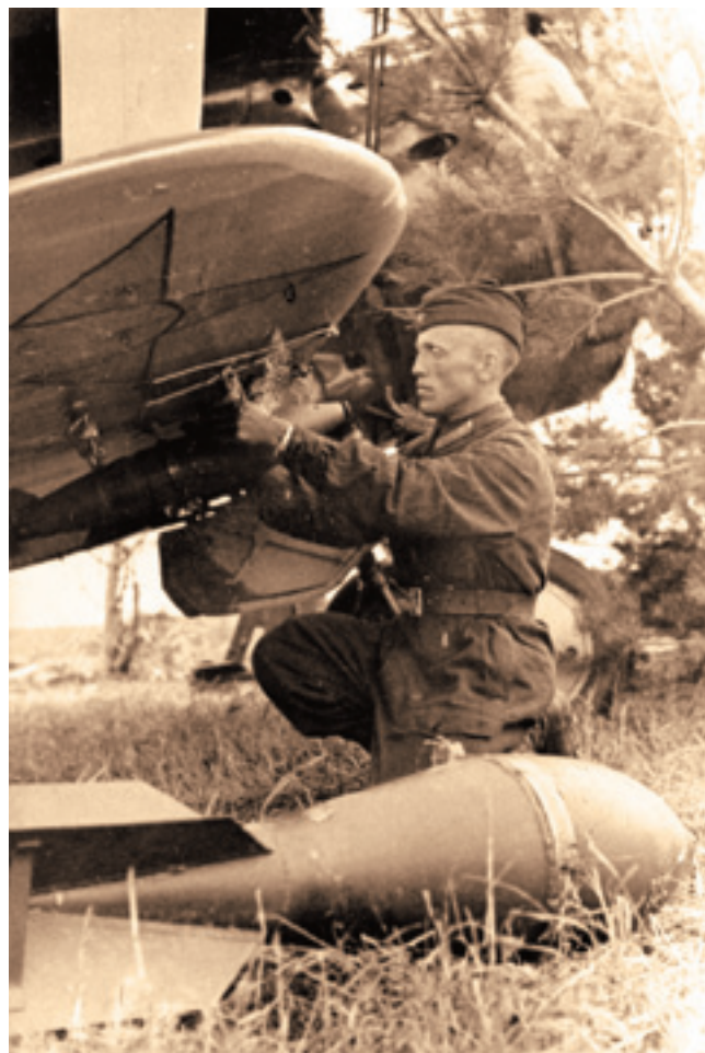
Подвеска бомб на штурмовик И-153 (на переднем плане бомба АФ-82, под крылом — малокалиберная бомба, переданная из артснаряда). Проволочные стержни предназначались для фиксации ветрянок взрывателей бомб
