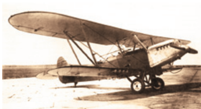
Самолет-разведчик Р-5 в годы войны в Испании нашел широкое применение в варианте штурмовика. На фото представлен вариант с восемью реактивными орудиями РО-82 («флейта-ми»), предназначенными для пуска РС-82
