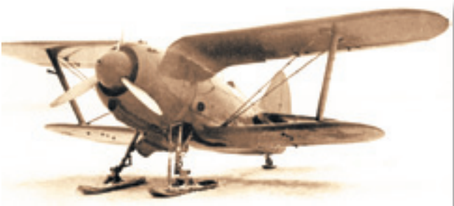
Последний изготовленный «в металле» биплан Н.Н. Поликарпова – истребитель И-190 с четырьмя пулеметами ШКАС
