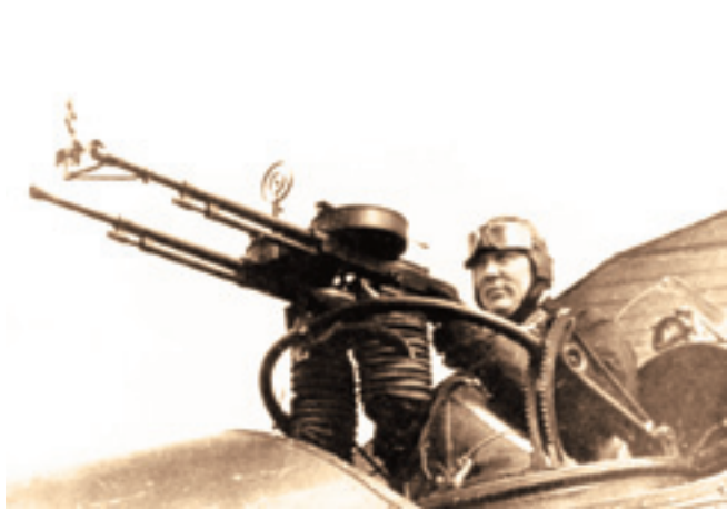
Спаренный пулемет ДА-2 на турели ТУР-6, установленной на самолете СССР (варианте Р-5 с мотором АМ-34). У дульного отверстия левого пулемета смонтирована так называемая «флюгер-мушка», обеспечивающая учет собственной скорости самолета при ведении огня вбок
