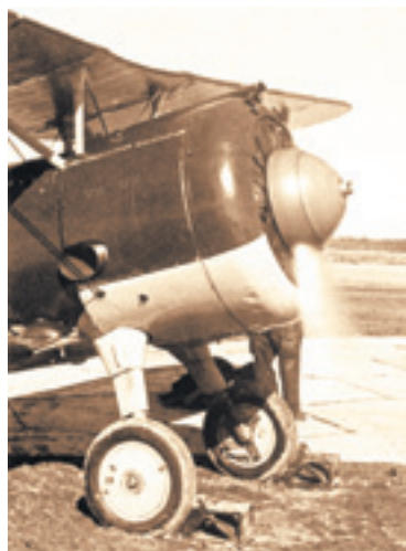
Самолет-истребитель И-5 на Центральном аэродроме (над головой механика, держащего лопасть винта, виден купол Петровского дворца). Пулеметы ПВ-1 располагались побортно в районе кабины пилота (закрыты обтекателями), для прохода траассы пуль в бортах фюзеляжа сделаны соответствующие желоба
