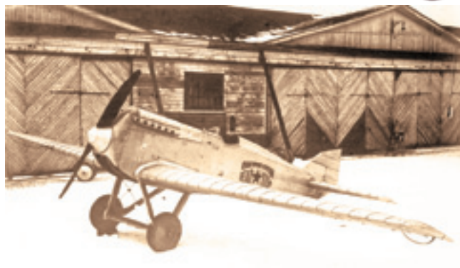
Первый истребитель конструкции Н.Н. Поликарпова – ИЛ-400 – не имел никакого отношения к С.В. Ильюшину. Буквы и цифры означали «истребитель с мотором «Либерти» мощностью 400 л.с.»
