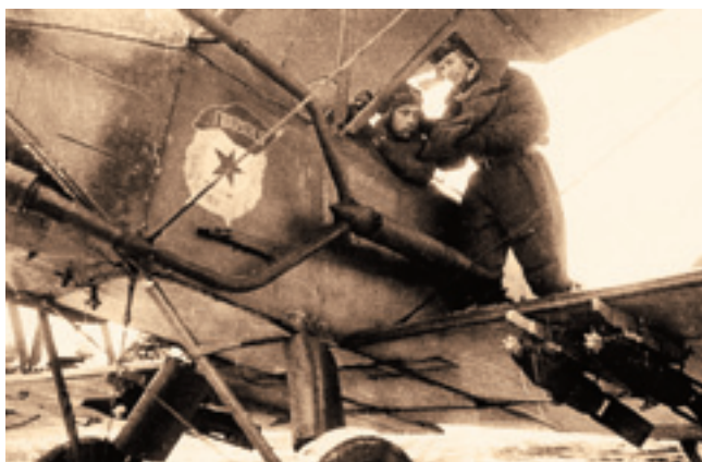
Легкий ночной бомбардировщик По-2ЛНБ с пламегасителями и четырьмя бомбами АО-25 под крылом. В СССР его называли «летающей партией» и «кукурузником», а немцы прозвали «швейной машинкой» за характерный звук мотора и «надоедливый сверчок» за то, что он не давал им спать по ночам
