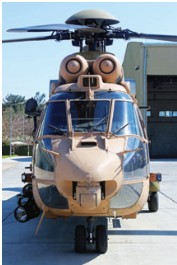
Спасательный вариант AS532USAR оснащён тепловизором и прожектором
