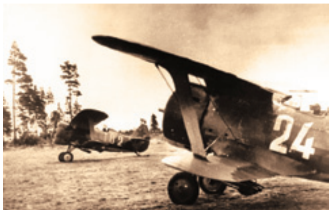
На боевое задание вырывают штурмовики И-153 «Чайка» с реактивными снарядами РС-82 под нижним крылом
