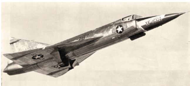
Первый YF-102A (53-1787) в момент уборки шасси после взлёта. Эти самолёты отличались от YF-102, в том числе более длинным фюзеляжем, большими крыльями типа Case X, более лёгким фонарём кабины и доработанной формой воздухозаборников
