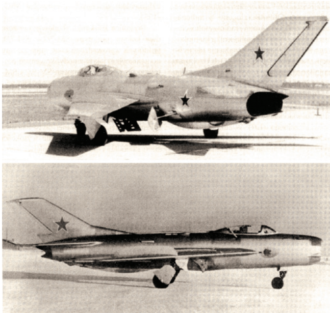
Модифицированные прототипы SM-7/2 и SM-7/3 имели цельноповоротный стабилизатор, третий воздушный тормоз под фюзеляжем, уменьшенный по высоте руль направления и увеличенный форкиль перед килем
