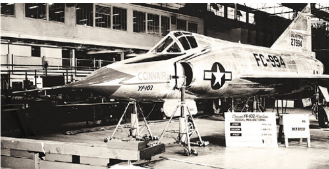
Прототип перехватчика YF-102 перед выкаткой из цеха. 15 октября 1953 г. Обратите внимание на короткий нос и широкий фонарь со множеством переплётов
