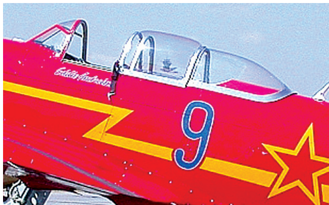
Вариант фонаря кабины на Як-9УМ: HB-RYA (№04704060) слева, N-900A (№0470401) справа
