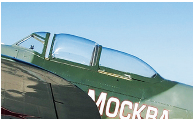
Вариант фонаря кабины на Як-9УМ: HB-RYA (№04704060) слева, N-900A (№0470401) справа
