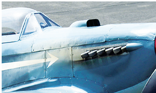
Воздухозаборники нагнетателя на Як-3М: VH-YZK (№0470102, слева) и D-FAFL (№0470110, справа)
