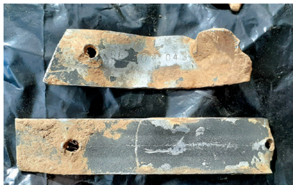
Оплетка фонаря Ju-88 с технологическими маркировками
