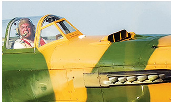
Воздухозаборники нагнетателя на Як-9УМ (Yak-9UM): D-FENK (№0470403, слева) и D-FIST (№0470408, справа)
