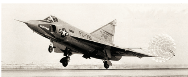
YF-102 (53-1781) при посадке с раскрытым тормозным парашютом. Видно, что парашют был выпущен до того, как колёса коснулись земли
