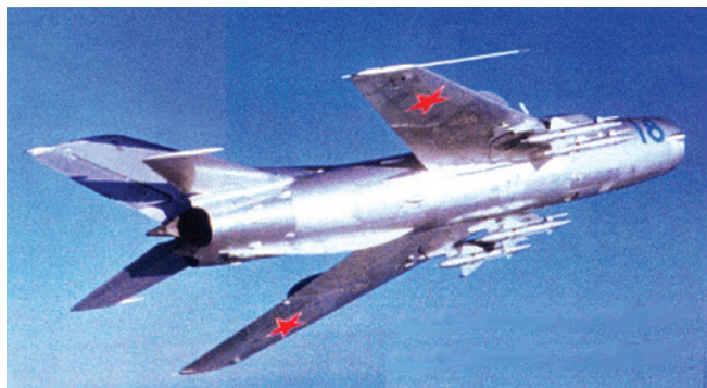
МиГ-19ПМ №18 в полёте с четырьмя ракетами РС-2У. Несмотря на то, что эти самолёты имели не самую лучшую репутацию, они оставались на вооружении до начала 1970-х годов
