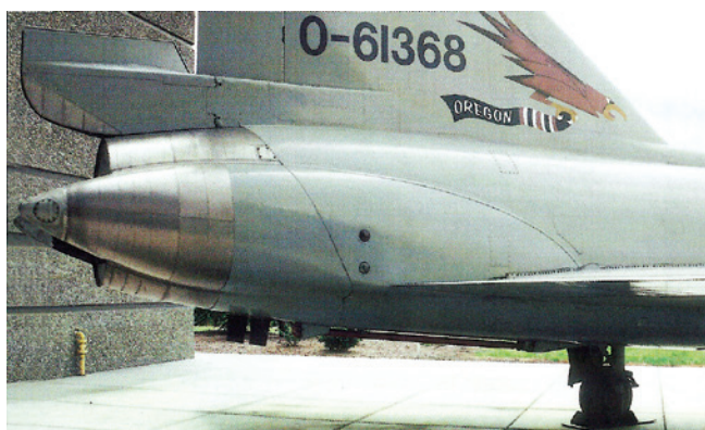
«Нашлёпки» на хвостовой части фюзеляжа сделаны для соблюдения правила площадей. Под фюзеляжем виден как для аварийного торможения
