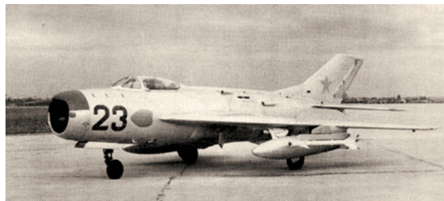
МиГ-19ПТ (СМ-7/2Т) №23, т.е. МиГ-19П, адаптированный в 1960-х годах для размещения на внешних пиллонах под крыльями управляемых ракет Р-3С (К-13А) с инфракрасным самонаведением
