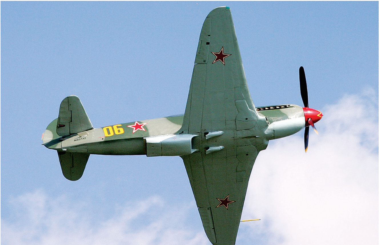
Yak-9UM N82112 (№0470406) Крыло с законцовками по типу Як-9 и механизацией по типу Як-3
