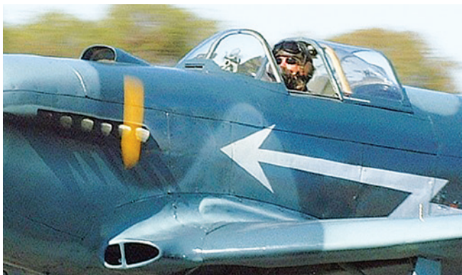
Воздухозаборники нагнетателя на Як-3М: VH-YZK (№0470102, слева) и D-FAFL (№0470110, справа)
