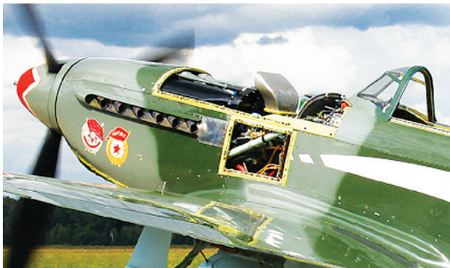
Воздухозаборники нагнетателя на Як-9УМ (Yak-9UM): D-FENK (№0470403, слева) и D-FIST (№0470408, справа)
