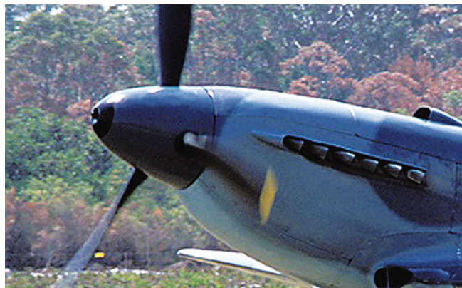
Воздушный винт Hamilton Standard на Як-3М №0470102: открытая втулка (слева) и удлинённый кок (справа)
