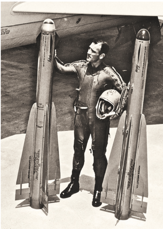
Слева – ракета GAR-2 (AIM-4B) с ИК головкой самонаведения. Справа – GAR-1D (AIM-4A) с ПА РЛС самонаведением. Ракеты имеют практически одинаковый планер. Рули отнесены от задней кромки крыла. На заднем плане – перехватчик F-102A
