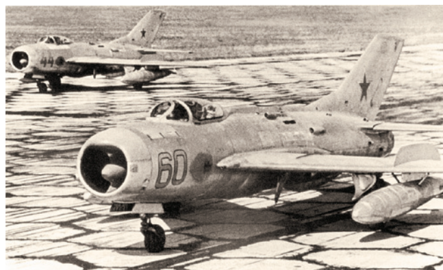
МиГ-19П стал первым сверхзвуковым перехватчиком, принятым на вооружение ВВС СССР. В 1956-1958 годах на заводе №21 в Горьком было выпущено 433 экземпляра этой версии
