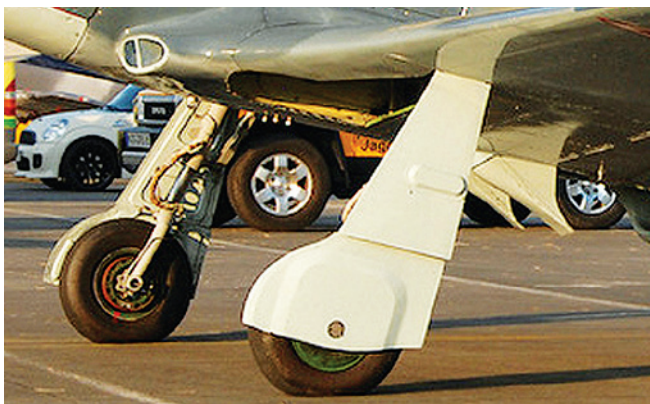
Щитки шасси: на Як-3М (№0470110, слева) и Як-9УМ (№0470402, справа)
