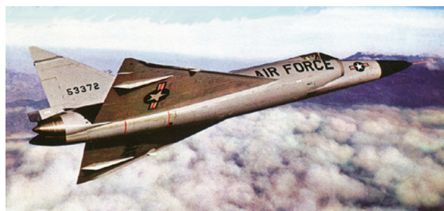
F-102A-41 (55-3372) в полёте. Начиная с этой серии, киль был увеличен для улучшения устойчивости на высоких скоростях. Отчётливо видны крылья типа «Case X» с загнутыми вниз передними кромками и слегка загнутыми вверх законцовками. Хорошо видны так же «нашлёпки» на хвостовой части фюзеляжа
