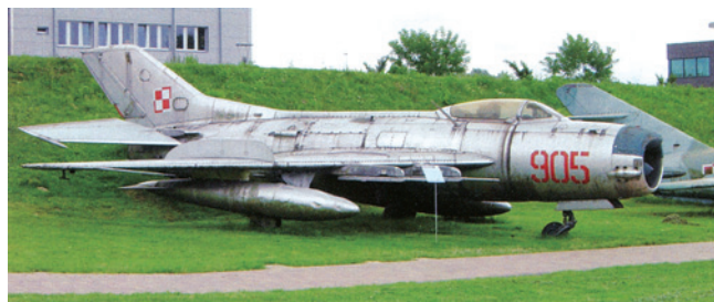
Польский МиГ-19ПМ №905 представлен в Музее польской авиации в Кракове. Вы можете видеть отклонённый цельноповоротный стабилизатор
