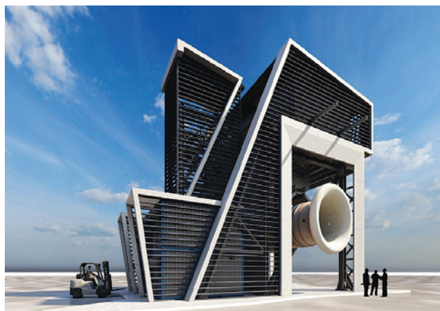
Открытый стенд для проведения испытаний двигателей сверхбольшой тяги
