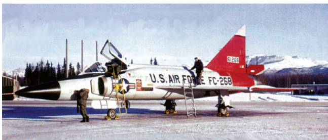
F-102A-70 (56-1268) из 317-й эскадрильи истребителей-перехватчиков на авиабазе Эльмендорф на Аляске в январе 1958 года. Самолёт уже имеет пластины – отсекатели пограничного слоя перед воздухозаборниками и увеличенные воздушные тормоза
