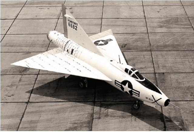
Демонстратор технологий. Самолёт с треугольным крылом XF-92A. На крыле и хвостовой части фюзеляжа наклеены ленточки для изучения обтекания в полёте. Самолёт имеет лобовой воздухозаборник, что затрудняло установку РЛС
