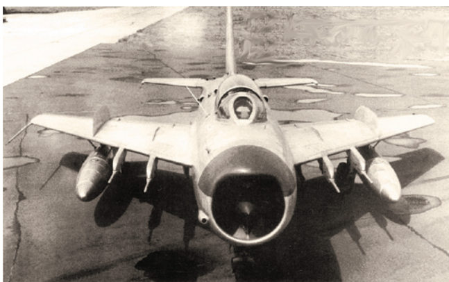
МиГ-19ПМ вид спереди. Хорошо видны четыре пилон с балками АПУ-4 для ракет РС-2У (К-5М), выступающие за переднюю кромку крыла. Эта версия была вооружена только управляемыми ракетами
