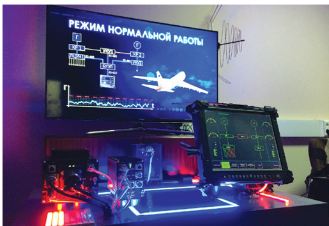
Демонстратор интеллектуальной системы электроснабжения НПО НаукаСофт
