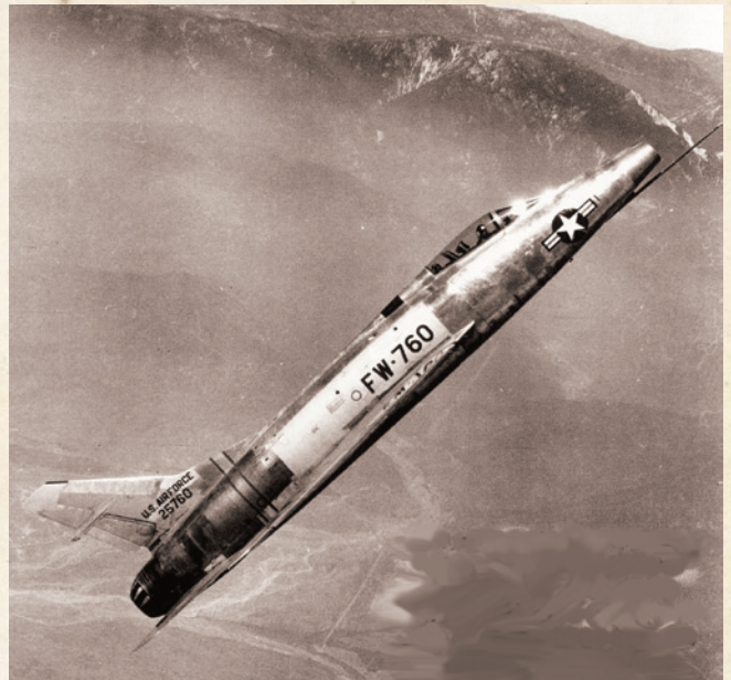
Пятый серийный F-100A-1 при наборе высоты под углом 45 град. Этот F-100A из первой производственной серии использовался для различных испытаний, чтобы помочь в устранении дефектов, обнаруженных во время испытаний прототипа
