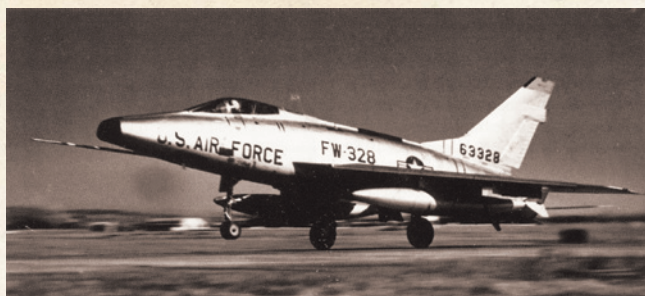
F-100D-90-NA из 405-го Эскадрильи тактических истребителей приземляется на базе Кларк на Филиппинах. Дополнительные топливные баки на 1268 литров подвешены под крыльями для использования на сверхзвуковой скорости
