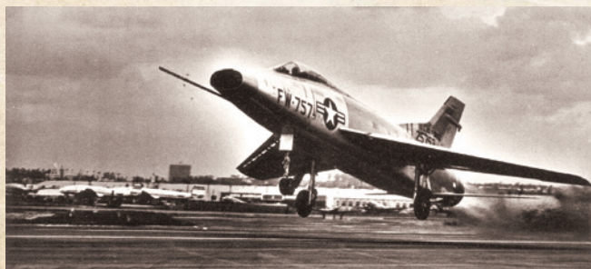
Второй серийный F-100A-1 во время взлёта. В отличие от прототипов, первые 70 F-100A изначально имели на 30 см более низкий вертикальный стабилизатор, который должен был предотвращать вибрацию руля направления
