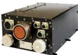
Локальный центр управления нагрузками
