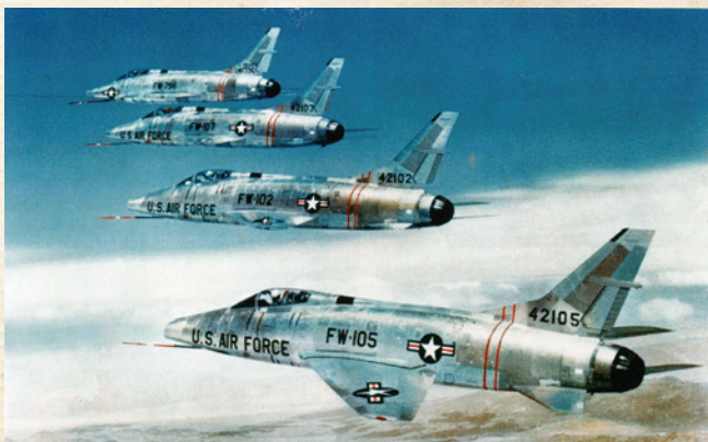
Звено F-100C в полёте. На переднем плане F-100C-25-NA. F-100C с двигателем J57-P-21 был самой быстрой высотной версией Супер Сейбра. Всего на заводах в Инглвуде и Колумбусе было изготовлено 476 F-100C
