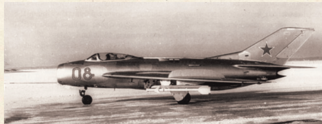
Экспериментальный СМ-9/3Т – один из МиГ-19С, использовавшихся в конце 1950-х годов для испытаний управляемых ракет К-13 (Р-3С)
