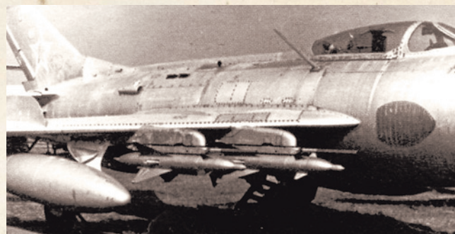
Управляемые ракеты РС-2УС под крылом перехватчика МиГ-19ПМ. Эти ракеты, управляемые «по лучу» в реальных боевых действиях показали малую эффективность
