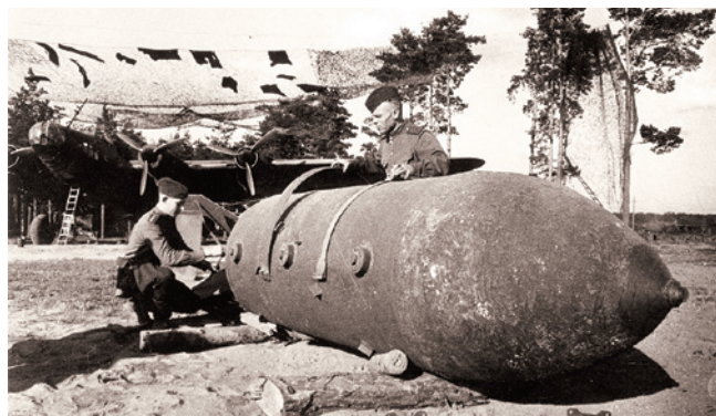
Оружейники 746-го ап дд готовят 5-тонную авиабомбу ФАБ-5000 к подвеске на бомбардировщик Пе-8.
