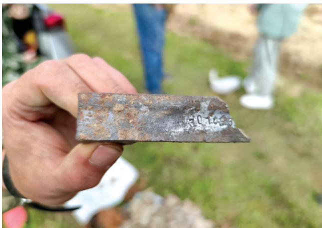
Фрагмент двигателя АМ-35А с номером С301043
