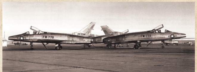
Сравнение низкого и высокого киль на двух F-100A-5. Высокий киль появился у 71-го серийного экземпляра, а затем последовательно и на ранее выпускавшихся машинах
