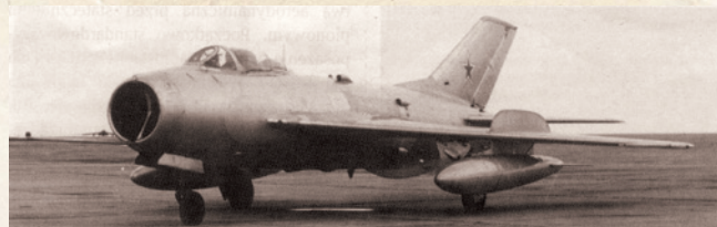
Первый полноценный прототип МиГ-19 — СМ-9/1 — ещё с гнутой перегородкой воздухозаборника. Самолёт совершил первый полёт 5 января 1954 г., а 19 марта достиг максимальной скорости 1450 км/ч ( M=1,33 ) в горизонтальном полёте на большой высоте
