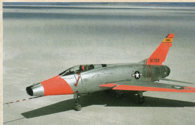
JF-100C, т.е. первый серийный F-100C-1, использовавшийся для испытаний на переменную устойчивость (в том числе по программе X-15) в Центре летных исследований NASA на авиабазе Эдвардс в начале 60 годов XX века
