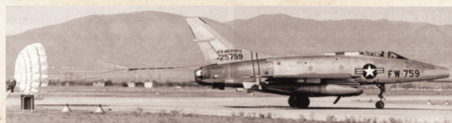
Четвёртый серийный F-100A-1 выполняет посадку с использованием тормозного парашюта. Высокая посадочная скорость была одним из наиболее серьёзных недостатков Супер Сейбра
