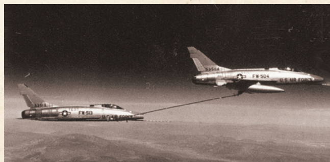
Два F-100D-20-NA при передаче топлива в полёте методом «напарника». Первая попытка дозаправки в полёте F-100D от другого F-100D была проведена 26 декабря 1956 года
