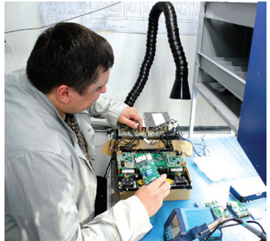
Сборка электронного преобразователя, сборочно-монтажный цех серийного производства
