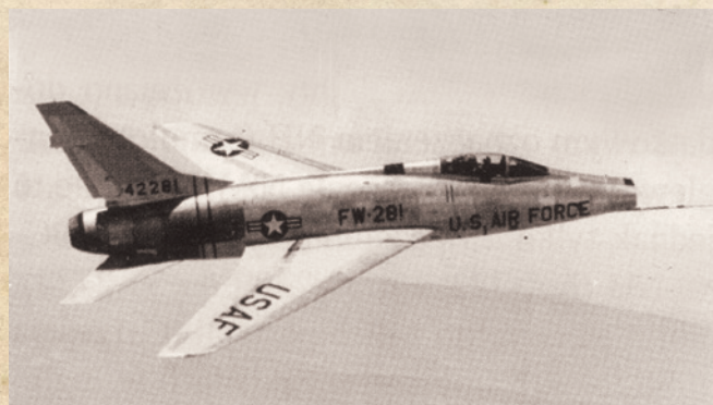
F-100D-15-NA в полёте. В этой версии, в частности, киль на 20 см выше, с более высоким рулем направления и увеличенным форкилём. Всего было выпущено 1274 F-100D, в том числе 940 в Инглвуде и 334 в Колумбусе
