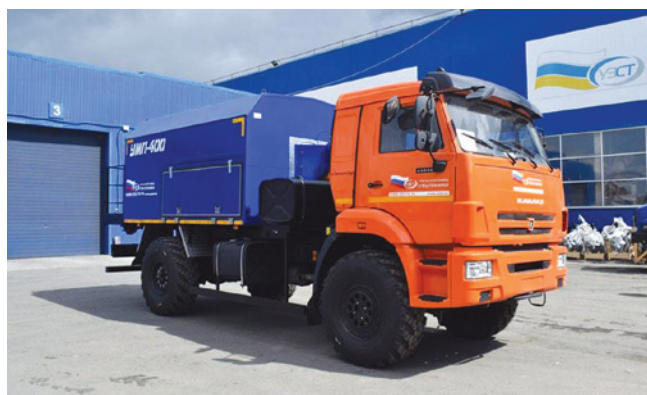
Рис. 5 – Моторный подогреватель УМП-400 (400 кВт тепловой мощности)
