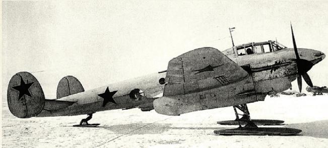
Пе-2 №11/16 с лыжным шасси на испытаниях
