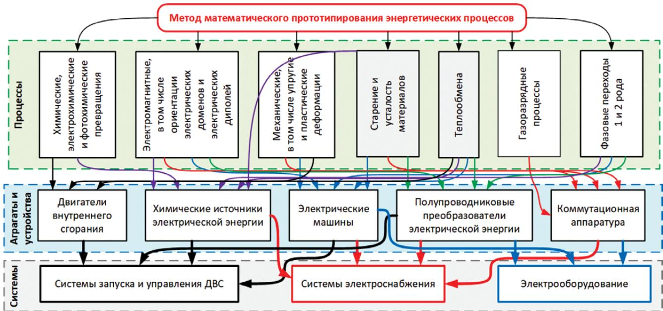
Рис. 3. Моделируемые процессы с применением ММПЭП
